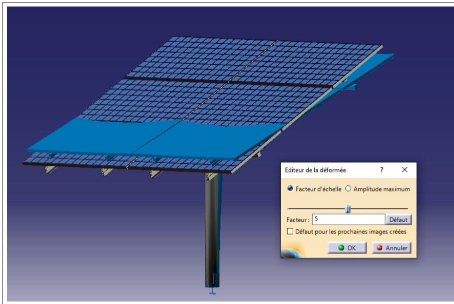
Figure 3.59 Déformée de UTPM6 sous CATIA - Vue de face
