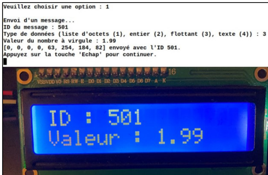
Figure 4.22 Envoi d'un nombre à virgule avec Canbus
