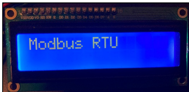
Figure 4.18 Photographie de l'écran LCD après réception d'une chaîne de caractères
