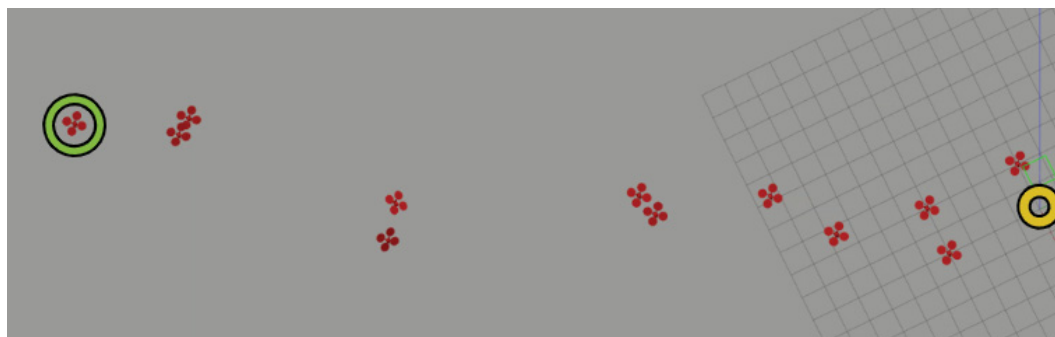
Figure 5.5 Exemple de chaîne avec un travailleur (vert) et 10 réseateurs forment deux liens avec la station de contrôle (jaune)
