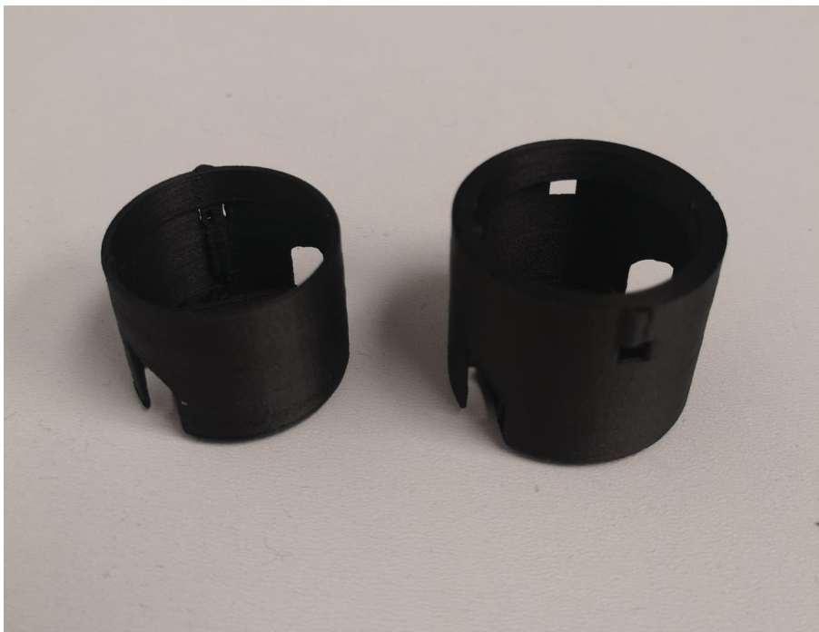
Figure 4.3 Les deux versions de châssis utilisées, l'originale (gauche) et améliorée (droite)
