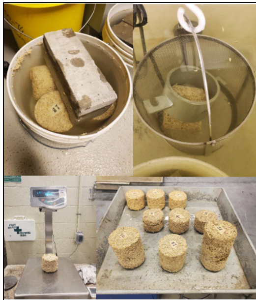
Figure-A III-20 Essai de la porosité ouverte à l'eau par immersion des bétons végétaux
