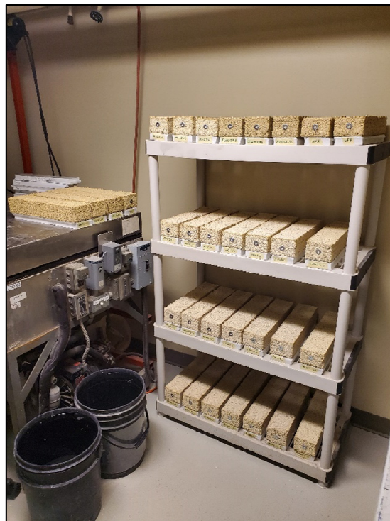
Figure-A III-10 Conservation des éprouvettes de poutre rectangulaire
