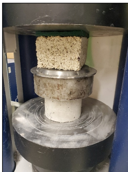
Figure-A III-14 Mise en place de l'échantillon pour l'essai de compression parallèle au sens de la compaction
