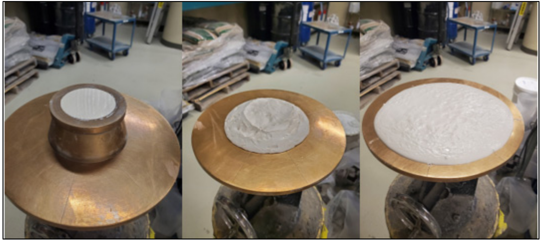
Figure 3.5 Essai d'étalement pour différent dosage en eau d'une pâte fraîche chaux-laitier de haut fourneau
