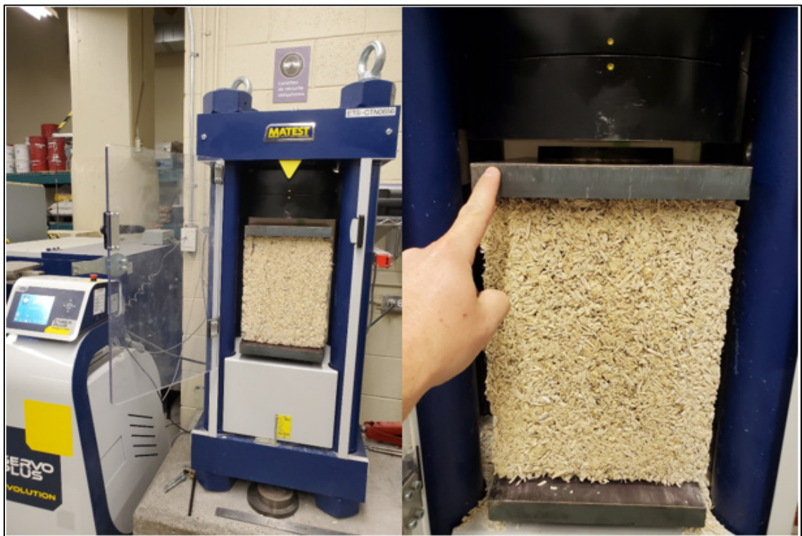
Figure-A III-21 Mise en place des blocs rectangulaires dans la presse hydraulique
