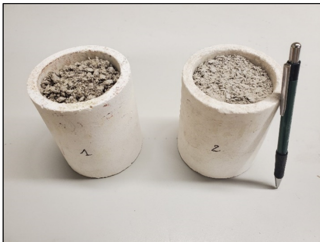
Figure-A II-2 Échantillons de boue de désencrage prêt pour l'essai de calcination; à gauche matière non broyée; à droite matière broyée
