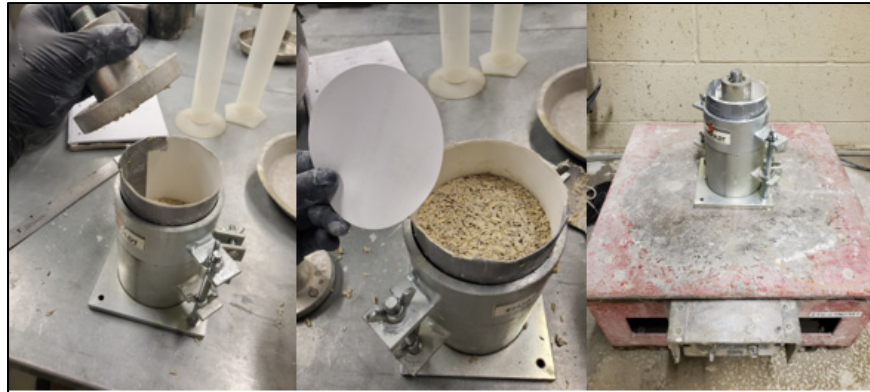
Figure-A III-25 Mise en moule des échantillons pour l'essai d'acoustique
