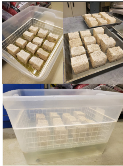
Figure-A III-16 Essai d'absorption d'eau par capillarité des bétons végétaux immergés
