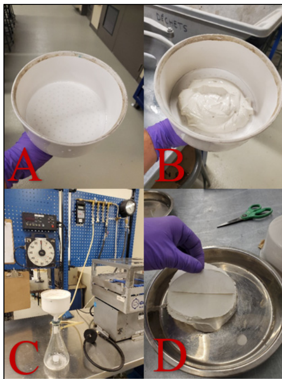
Figure 3.6 Essai de rétention d'eau d'une pâte à l'état frais; photo A : mise en place du papier filtre humide; photo B : dépôt de la pâte fraîche sur le papier filtre; photo C : pâte fraîche mise sous vide; photo D : retrait du papier filtre en vue de faire l'étalement final
