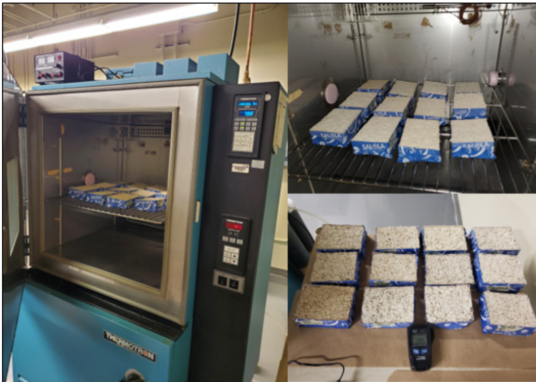
Figure 3.14 Essai de la Valeur de la Capacité de Tampon Hydrique ou «Moisture Buffering Value»
