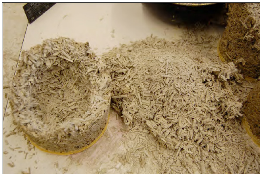
Figure-A III-13 Phénomène de farinage au cœur d'un béton végétal de Hirst (2013)
