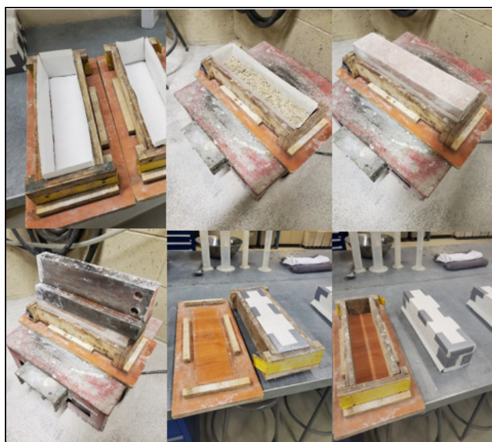
Figure-A III-9 Mise en place des bétons de végétaux de poutre rectangulaire
