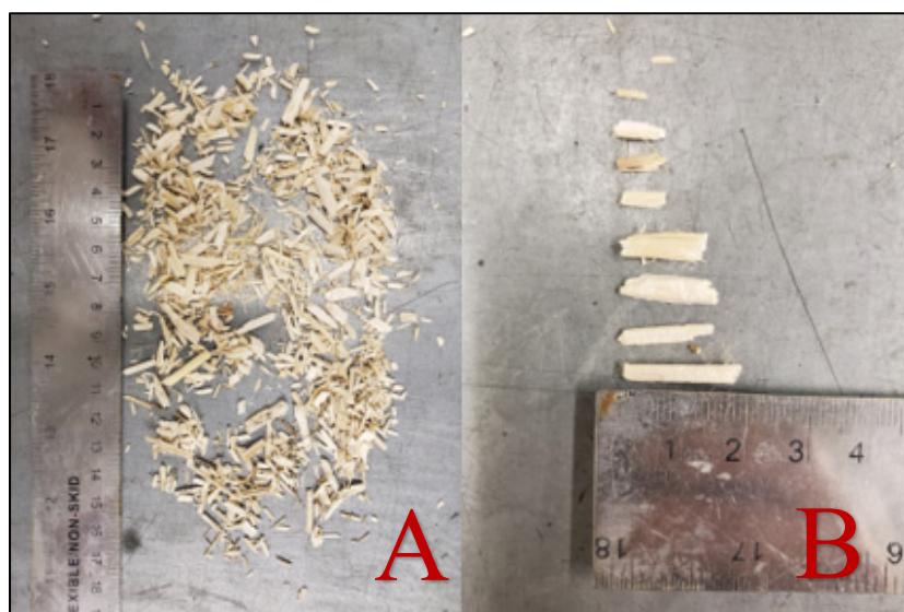
Figure-A III-4 Dimensions de la chènevotte reçue du Québec, la photo A présente un échantillonnage aléatoire et la photo B présente un échantillonnage sélectif
