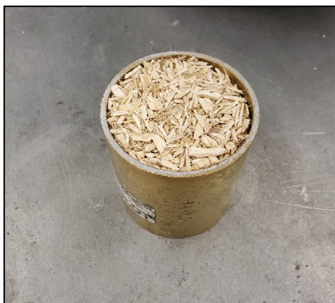
Figure-A III-1 Détermination de la masse volumique apparente tassée de la chènevotte dans un cylindre normalisé de 400 ml
