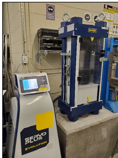
Figure 3.9 Presse hydraulique pour l'essai de compression mécanique
