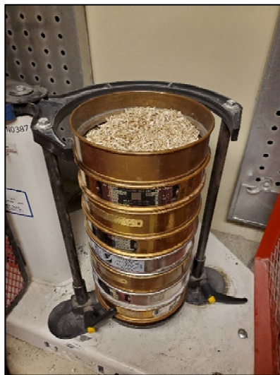
Figure-A III-5 Granulométries par tamisage de la chènevotte
