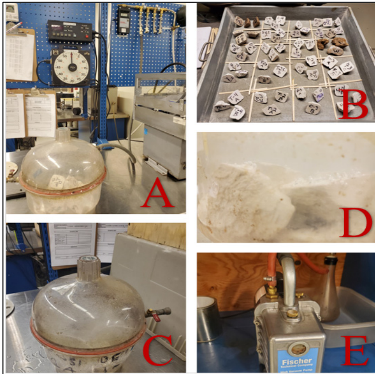
Figure 3.11 Essai de la porosité ouverte à l'eau par immersion; photo A : mise des échantillons submergés sous vide; photo B : disposition des échantillons pour la mise à l'étuve; photo C : conservation des échantillons submergés 24 heures; photo D : microbulles sortantes des échantillons durant l'essai; photo E : pompe à l'air utilisée pour l'essai
