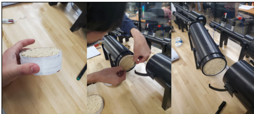
Figure-A III-26 Mise en place de l'échantillon dans le tube d'essai acoustique
