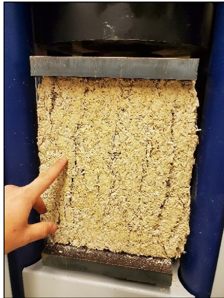
Figure-A III-22 Compression perpendiculaire au sens de la compaction des blocs rectangulaires
