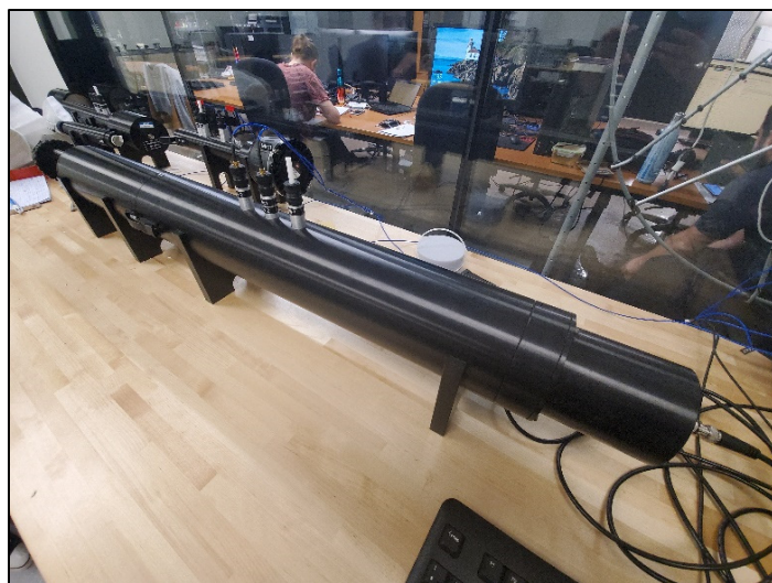
Figure-A III-27 Tube et microphones de l'essai acoustique
