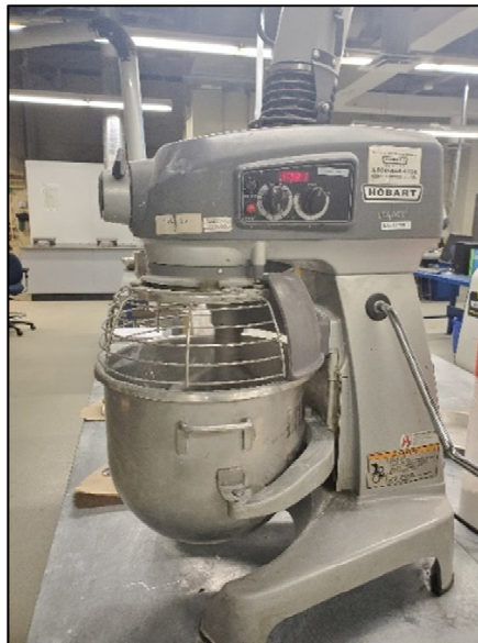
Figure 3.3 Robot à mortier de type Hobart
