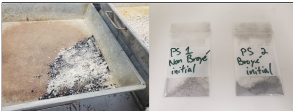
Figure-A II-3 Échantillons suivant l'essai de calcination avant l'essai thermogravimétrique (TGA) post-calcination
