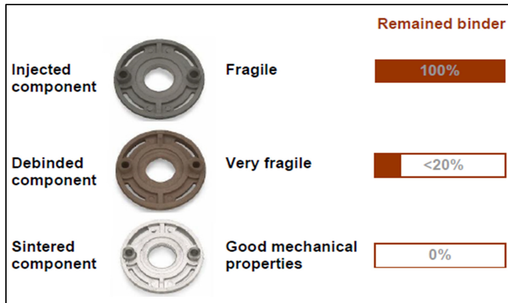
Figure 1.11 État de propriétés mécaniques d'une pièce réalisé par le procédé MIM à différente étape du procédé
