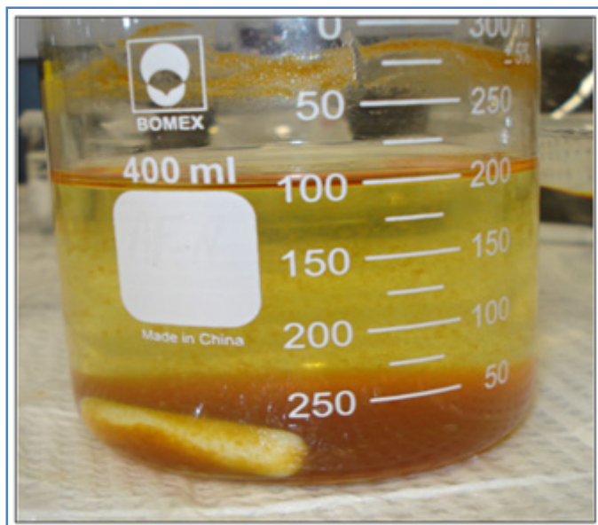
Figure 3.6 Solution trouble à la fin de la réaction (électrodes en acier inoxydable).
