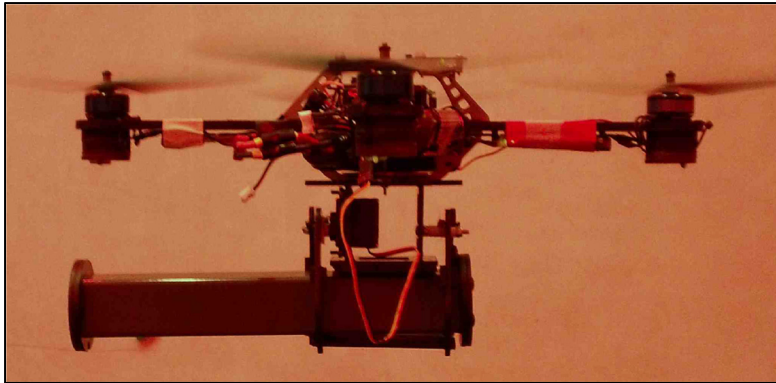
Figure 1.3 Drone avec pince ventrale pour la saisie et le transport d'objets
