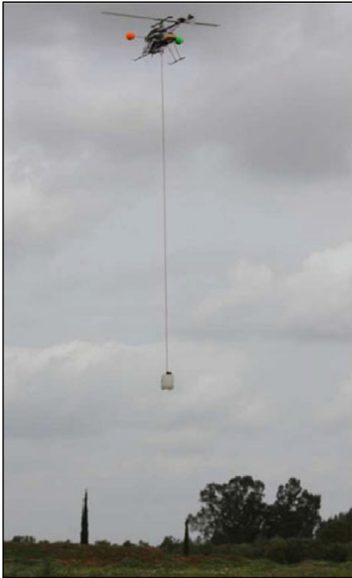
Figure 1.1 Manipulation de charge avec hélicoptère munie d'une corde
