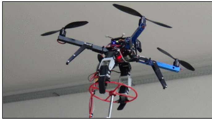
Figure 1.6 Système aérien d'ouverture de valve avec deux bras manipulateurs à 2 DDL
