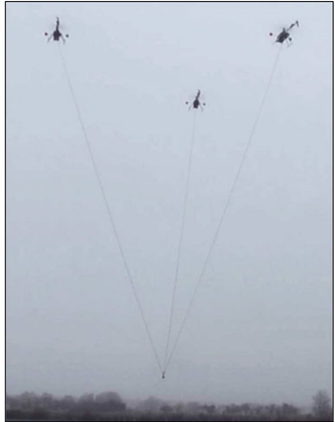
Figure 1.2 Manipulation coopérative de charge avec trois hélicoptères
