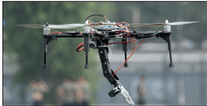
Figure 1.4 Drone muni d'un bras manipulateur sériel à 2 DDL
