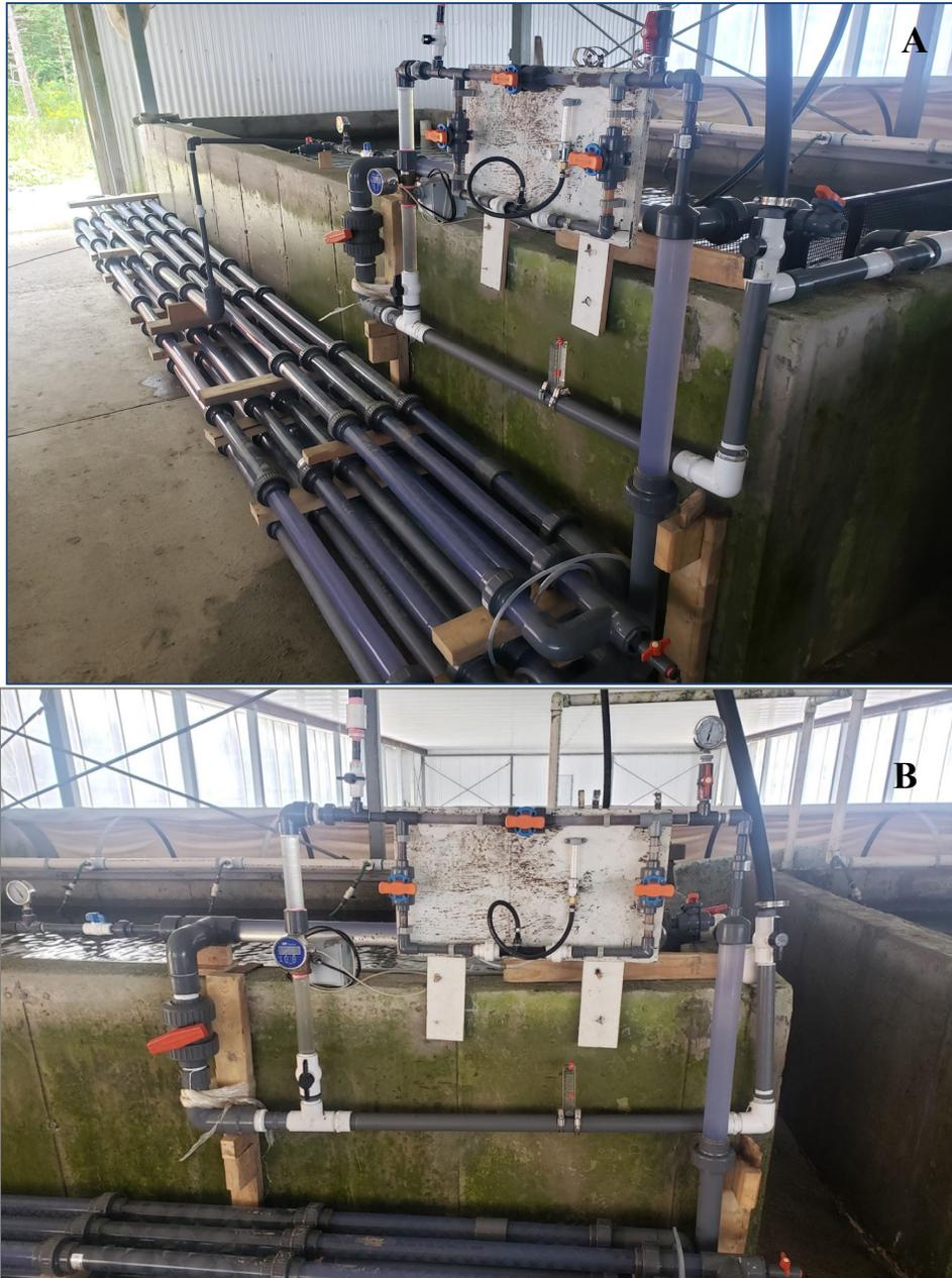
Figure-A I Réacteur tubulaire sous pression d'ozonation
