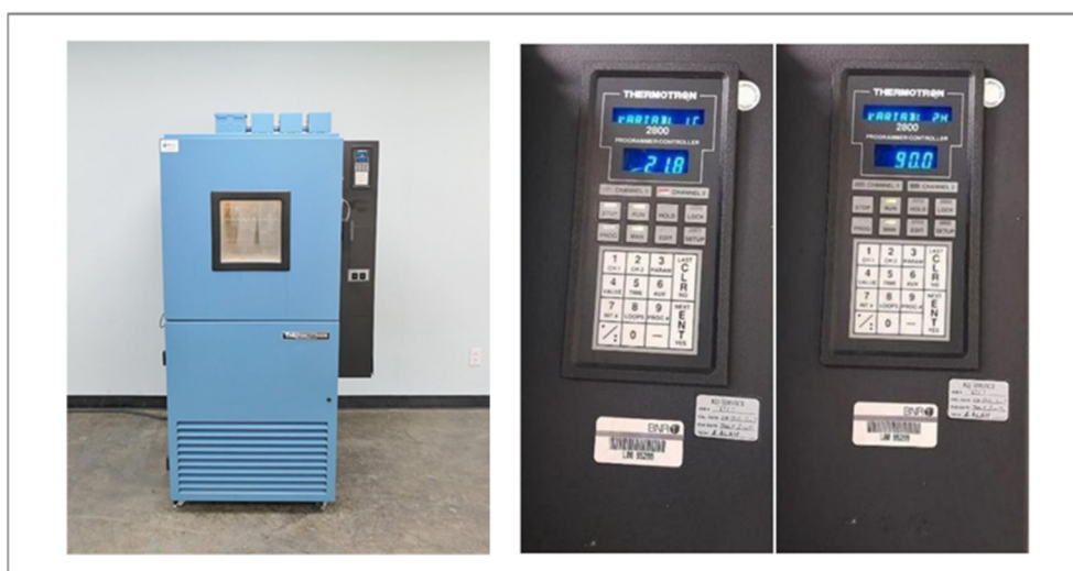
Figure 2-23 Chambre climatique ThermoThron maintenue à une T = 22^{\circ}\text{C} et une \text{HR} = 90\%
