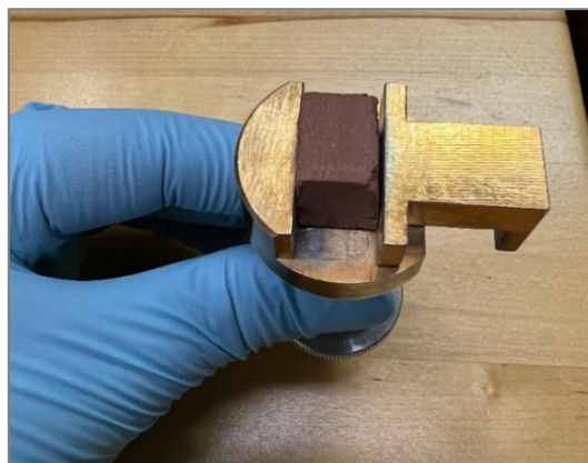
Figure-A II-2 : Mise en place de l'échantillon dans la porte-échantillon et ajustement de la hauteur
