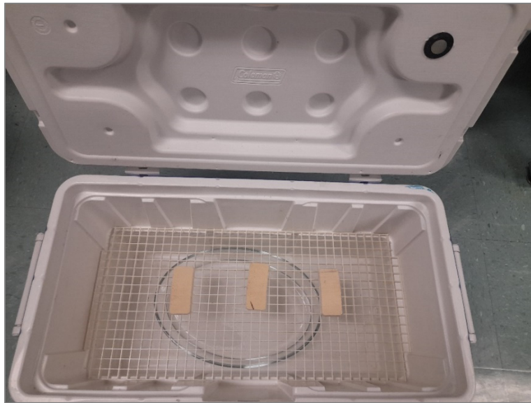
Figure-A I-1 : mise en place des échantillons de bois dans le récipient hermétique
