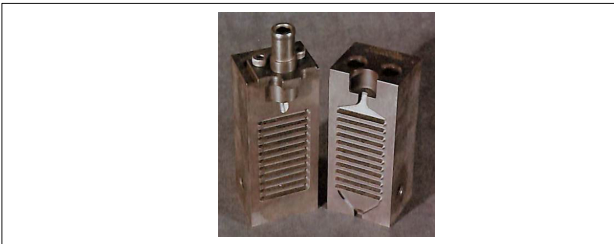
Figure 1.22 Remplacement de valve pour le VPDC
