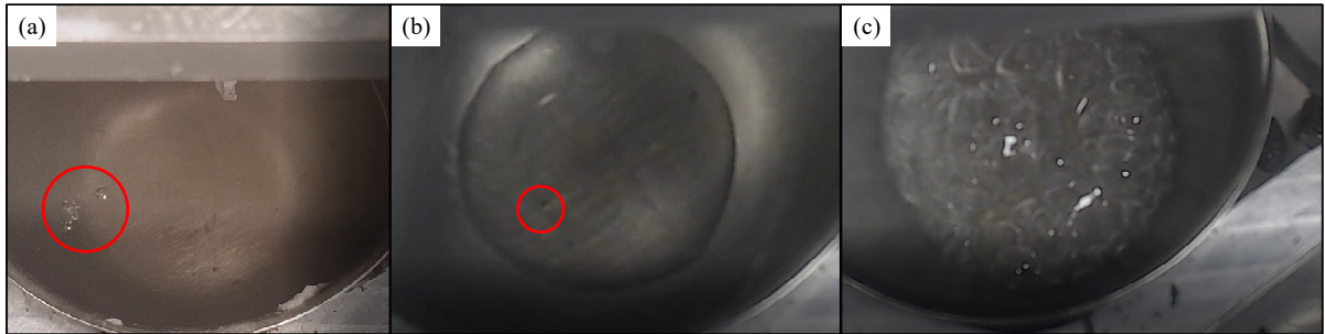
Figure 4.2 État des trois liants polymériques non dégazés lors d'une mise sous vide : (a) cire de paraffine, (b) acide stérique et (c) éthylène-acétate de vinyle
