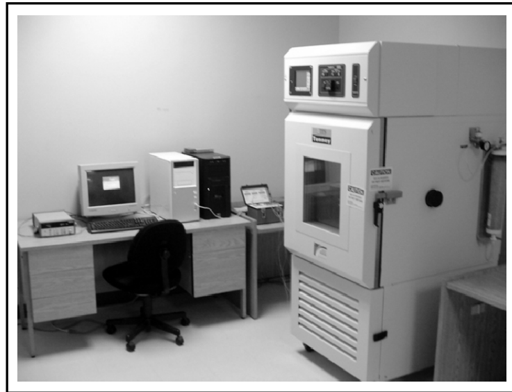
Figure 2.2 Chambre environnementale et système d'acquisition de données.
