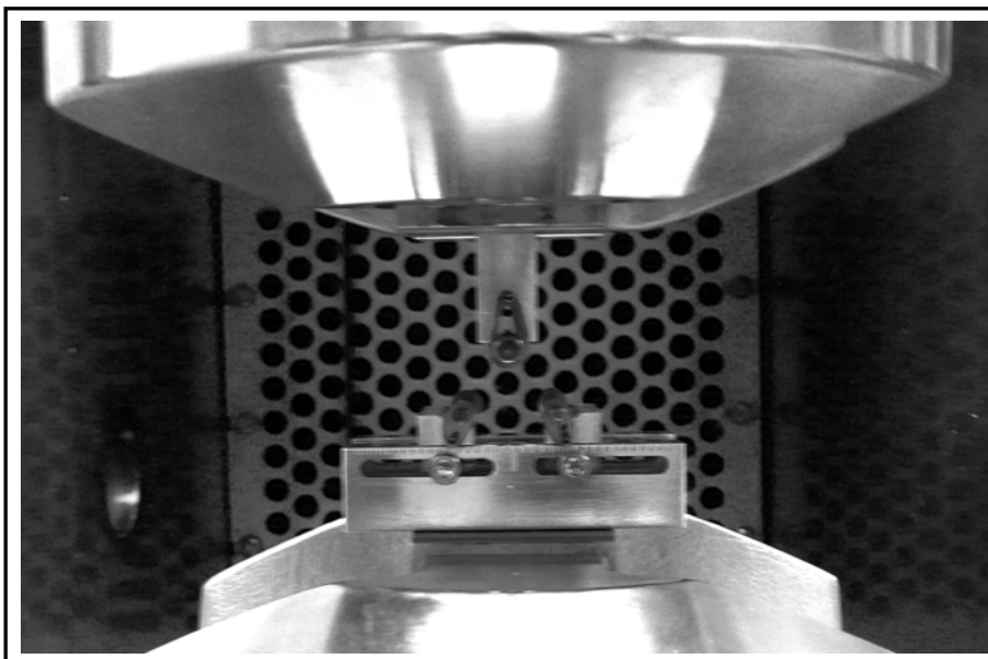
Figure 2.4 Montage de flexion en poutre courte (ILSS).
