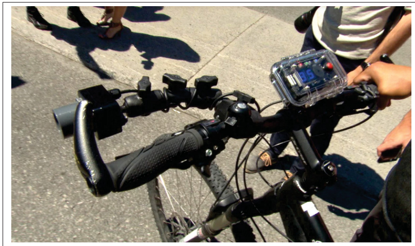
FIGURE 0.4 Image d'un radar pour mesurer la distance lors d'un dépassement d'un vélo. Le radar, à émission laser, est installé sur le guidon du vélo du policier Tirée de Maisonneuve & Lemieux (2018)
