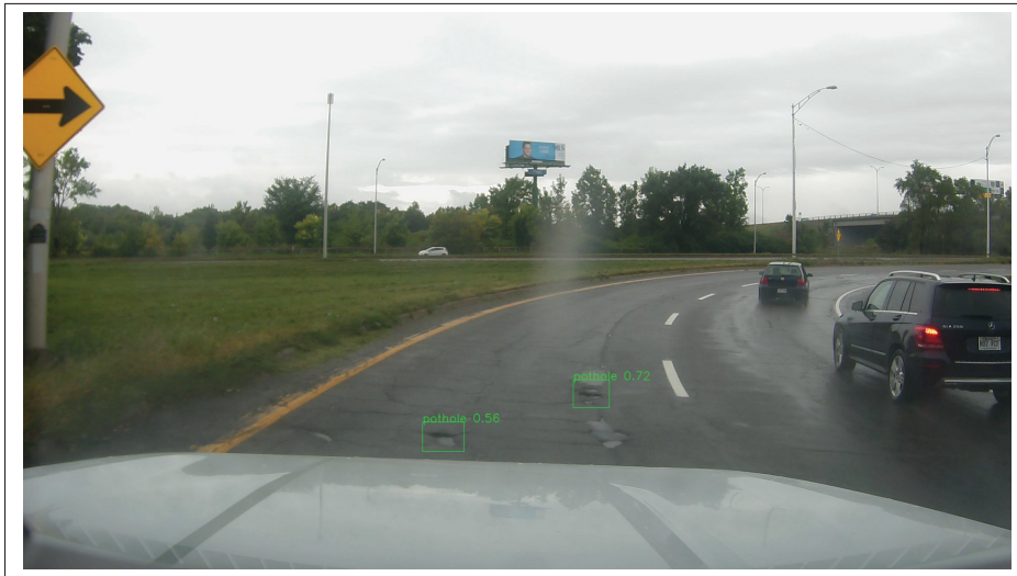
FIGURE 3.4 Exemple de vrai positif de détection de nids de poule
