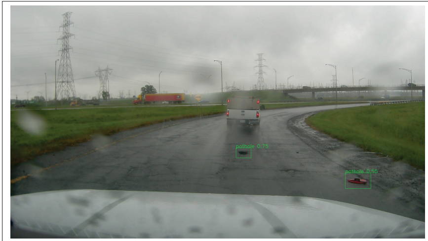
FIGURE 3.12 Détection d'un débris comme nid de poule (FP)
