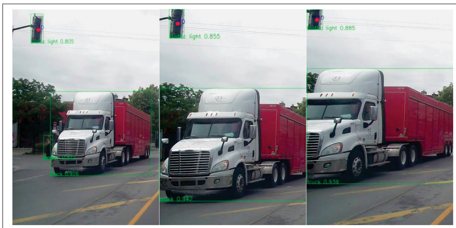
FIGURE 5.10 Exemple du changement de la forme de la boîte englobante
