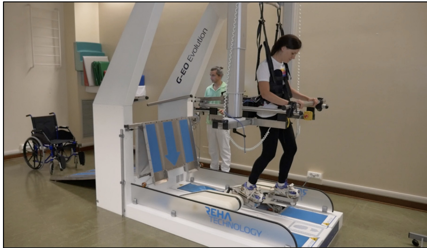
Figure-A III-2 Entraînement à la marche assistée par robot : Exemple du GE-O Tirée de Gandolfi et al. (2019)
