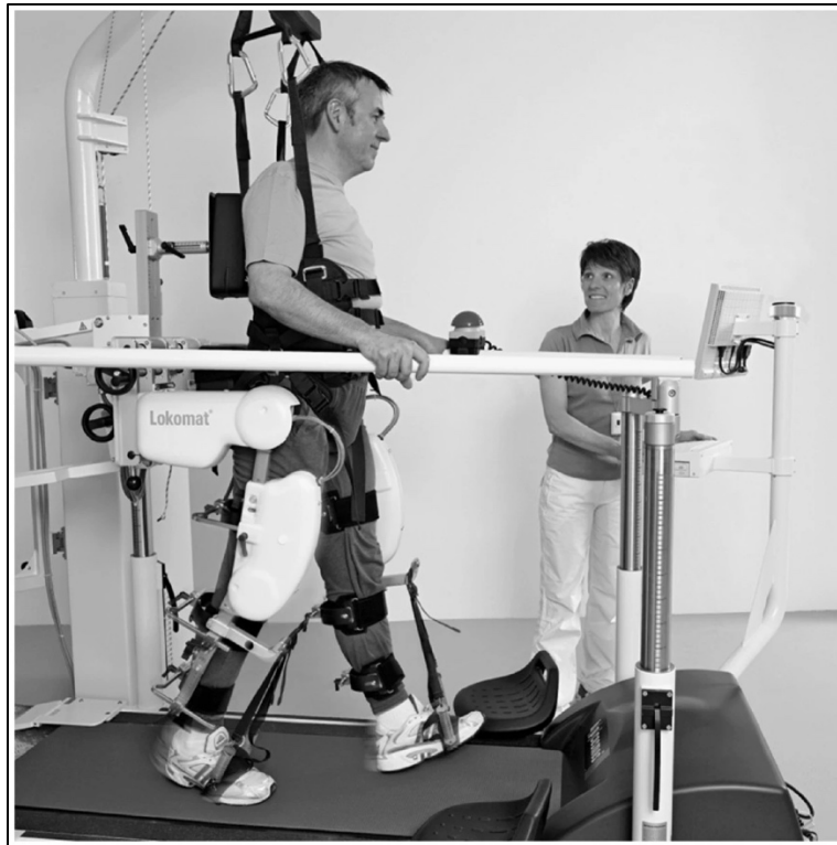
Figure-A III-1 Entraînement à la marche assistée par robot : Exemple du Lokomat Tirée de Schück et al. (2012)
