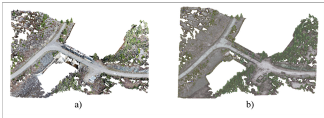
Figure 6.1 a) Nuage de points obtenu avec la photogrammétrie par drone avec les attributs RGB obtenu lors de l'acquisition. b) Attributs R, G et B obtenu à l'aide d'un réseau de neurones prenant en entrée le vecteur d'attributs calculé
