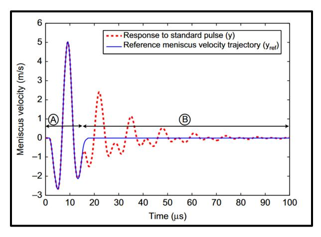
Figure 4.6 Vitesse du ménisque d'une buse dans le temps selon deux types de commande Tirée de Khalate (2011, p. 4)
