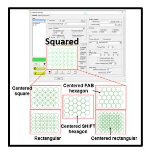
Figure 4.4 Contrôle du type de remplissage Céradrop
