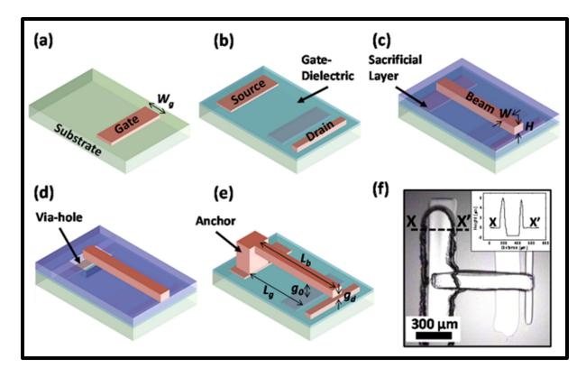
Figure 2.1 Méthode de fabrication successive d'un relais imprimé par jets d'encre. Tiré de Park et al., (2013, p. 2)
