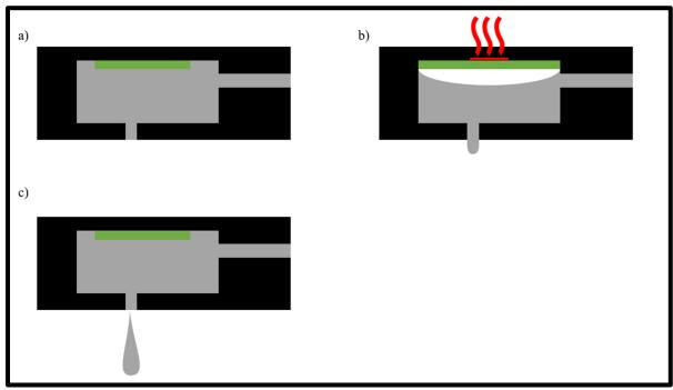
Figure 1.4 Représentation d'une buse thermique lors de l'éjection d'une gouttelette a) au repos, b) lorsque l'élément évapore le solvant, c) lorsque la température redescend et que la gouttelette est éjectée
