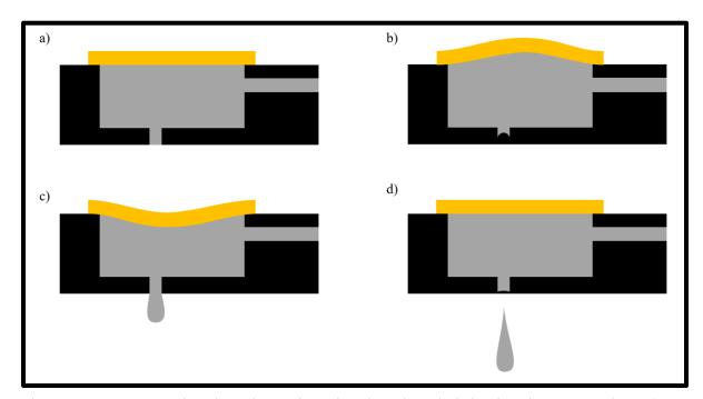
Figure 1.3 Représentation d'une buse piézoélectrique lors de l'éjection d'une gouttelette a) au repos, b) lorsqu'un voltage positif est appliqué à l'élément piézoélectrique, c) lorsqu'un voltage négatif est appliqué et d) lorsque la gouttelette est expulsée et que la tête retourne au repos
