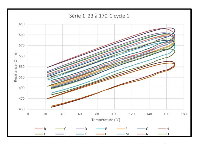
Figure 6.2 Résistance électrique selon la température cycle initiale Série 1
