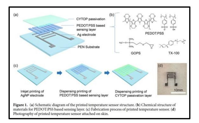
Figure 2.3 (a) Diagram du capteur de température imprimé. (b) structure chimique de la couche sensible de PEDOT:PSS. (c) Processus de fabrication du capteur de température imprimé. (d) Image du capteur imprimé attaché à la peau. Tirée de (Wang et al., 2020)
