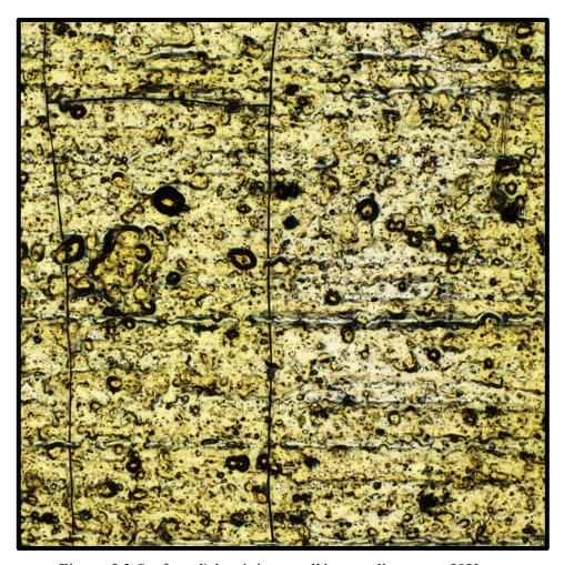
Figure 5.3 Surface d'aluminium scellé agrandissement 50X
