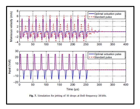
Figure 1.2 Simulation de la formation de 10 gouttelettes d'encre à 38 kHz Tiré de Khalate (2011, p.7)
