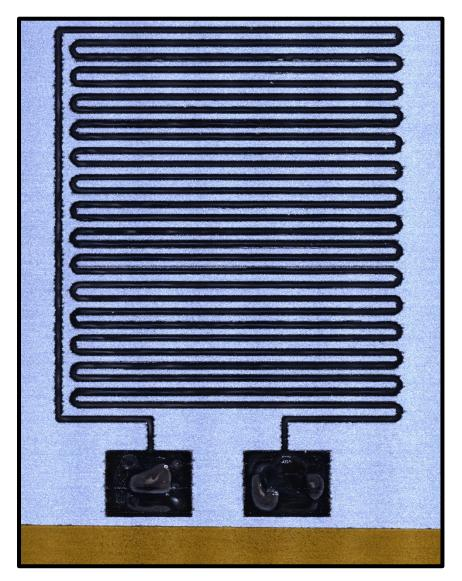
Figure 4.7 Thermistance imprimée en argent non fritté
