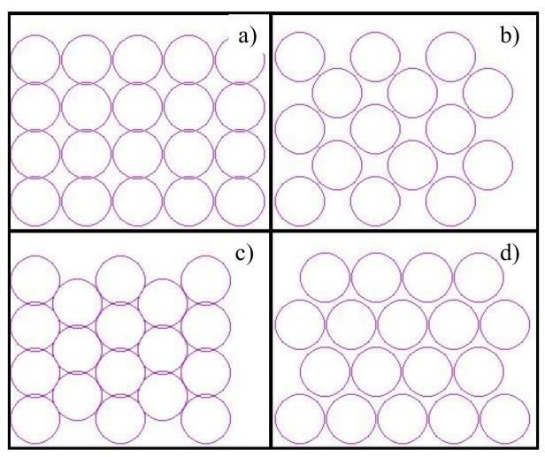
Figure 3.1 Types de remplissages « square » a) « centered square » b) « shift hexagonal » c) et « fab hexagonal » d)
