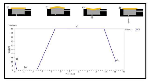
Figure 4.5 Représentation de la buse piézoélectrique selon le voltage appliqué dans le temps
