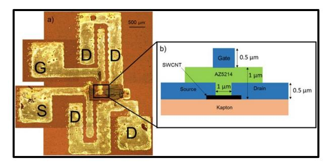
Figure 2.2 Image composée du transistor fabriqué a) et une représentation en vue de coupe des différentes couches
