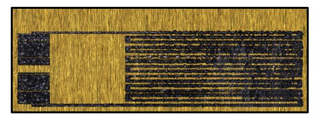
Figure 5.5 Effet d'un type de remplissage carré centré et d'un croisement de trame trop faible
