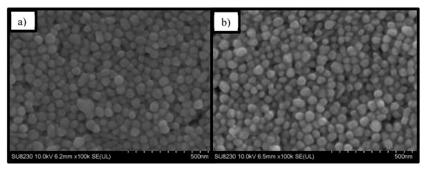
Figure 6.1 Image prise au microscope électronique à balayage des échantillons frittés une heure a) et cinq heures b)
