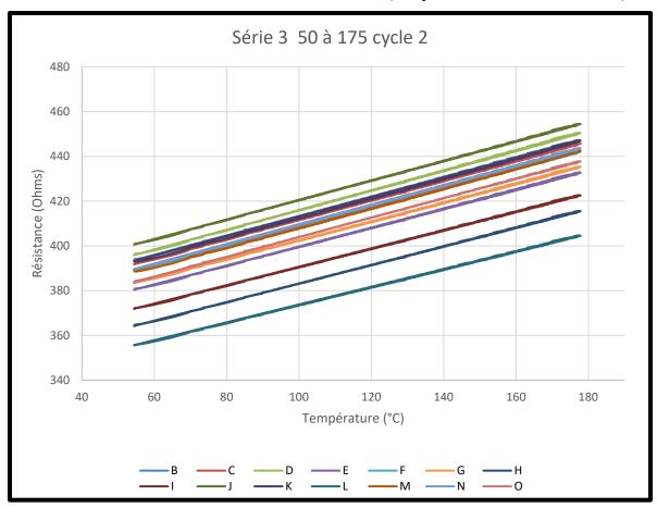
Figure 6.3 Résistances électriques selon la température cycle initiale Série 3 Cycle 2
