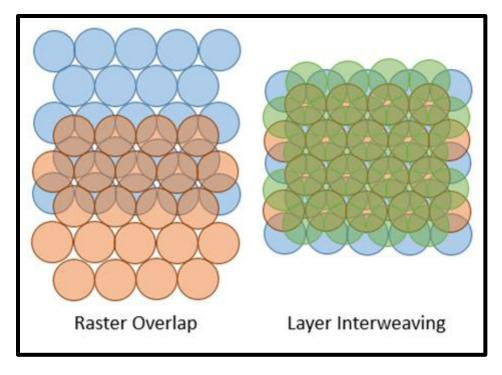
Figure 5.6 La différence entre le "Raster Overlap" et le "Layer Interleaving Tirée de Trudeau (2021, p. 120)
