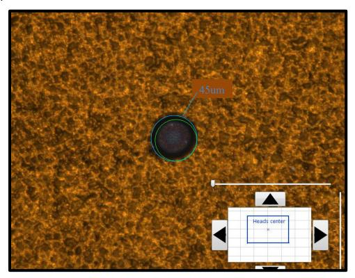
Figure 5.7 Taille d'une gouttelette sur le substrat
