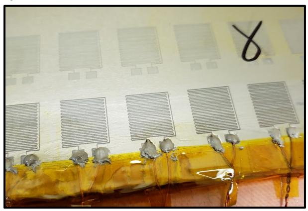
Figure 5.8 Capteurs imprimés et connectés.
