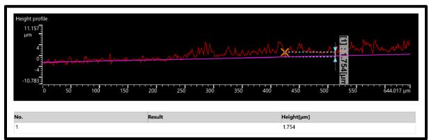
Figure 5.2 Mesure de l'épaisseur de la couche du scellant sur le substrat d'aluminium avec le microscope LEXT OLS5000 d'Olympus
