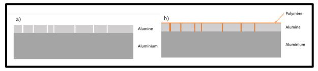
Figure 5.1 Représentation en vue de coupe du substrat d'aluminium avant scellant a) et après application du scellant polymérique
