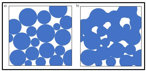
Figure 2.4 Représentation des particules d'argent avant frittage a), et après frittage b)
