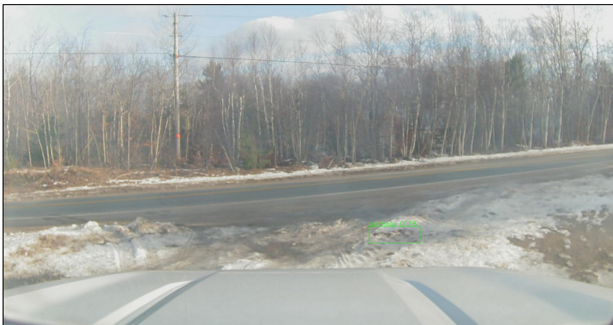
Figure 4.2 Exemple de nid de poule faux positif (FP)
