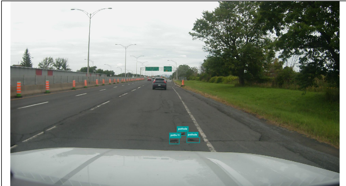
Figure 3.5 Exemple des petits nids de poule
