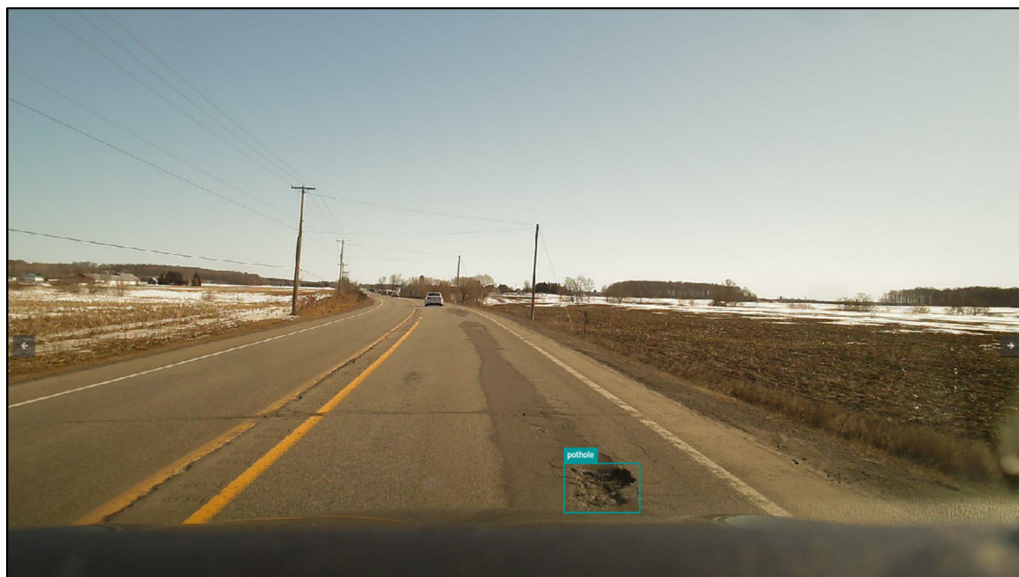
Figure 3.4 Cas d'un nid de poule identifié comme évident dans le jeu de données
