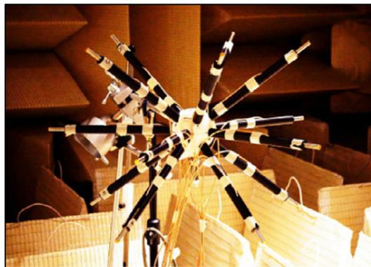
Figure 1.15 Antenne sphérique de 15 microphones avec tiges de 20 cm et un noyau sphérique de 7.62 cm de diamètre pour obtenir un diamètre d'antenne de 50 cm
