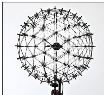
Figure 1.20 Antennes sphériques ouvertes à structure filaire commerciale de 120 microphones
