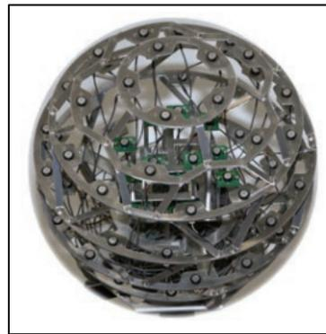
Figure 1.11 Antenne sphérique ouverte de 64 microphones faite à base de plusieurs anneaux concentriques
