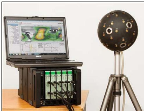
Figure 0.7 Système d'imagerie acoustique avec antenne sphérique de microphones rigide
