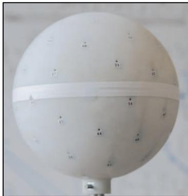
Figure 1.24 Antenne rigide de 64 microphones et de 20 cm de diamètre
