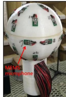
Figure 1.25 Antenne sphérique rigide de 32 microphones et de 5 cm de rayon
