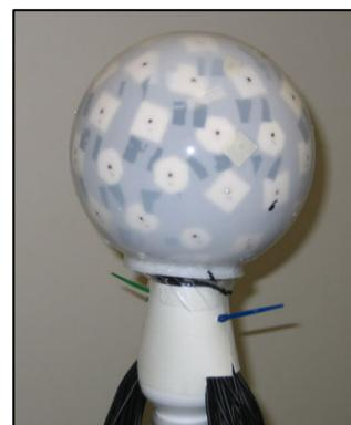
Figure 1.22 Antenne sphérique rigide de 60 microphones de 20.2 cm
