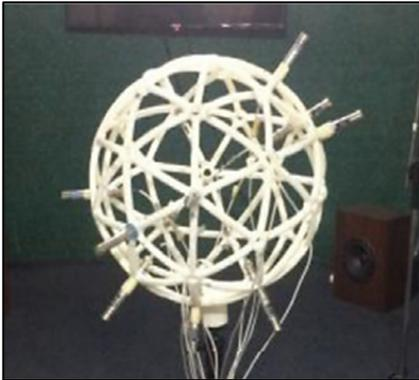
Figure 1.16 Antenne sphérique de 36 microphones à structure filaire de 40 cm de diamètre
