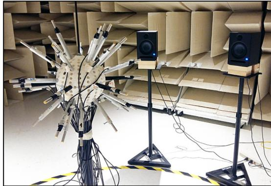
Figure 1.17 Antenne sphérique ouverte avec tiges modulaires avec 252 positions possibles et de 40 cm de diamètre
