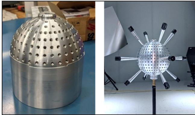
Figure 3.4 Usinage du noyau sphérique en aluminium et antenne ouverte modulaire avec tiges assemblées
