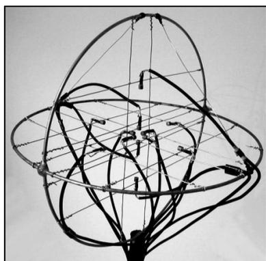
Figure 1.8 Antenne sphérique ouverte de 12 microphones à base d'anneaux et de câbles
