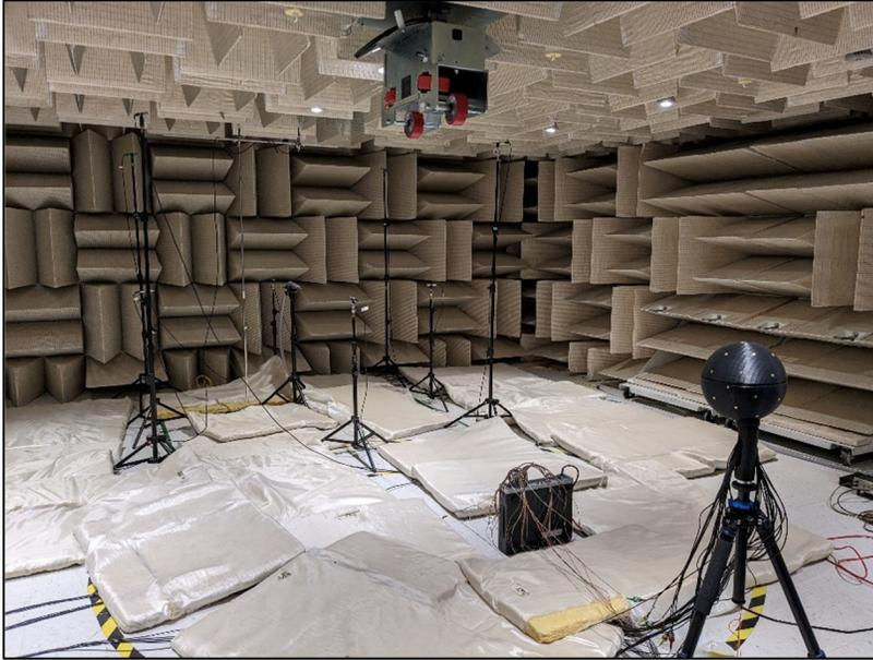
Figure-A II-2 Montage en chambre semi-anéchoïque avec la source ponctuelle LMS devant l'antenne rigide de 36 microphones. Pour cette configuration, la source n'est pas à 1m de l'antenne. Des matelas de fibre de verre sont placés au sol pour atténuer les réflexions
