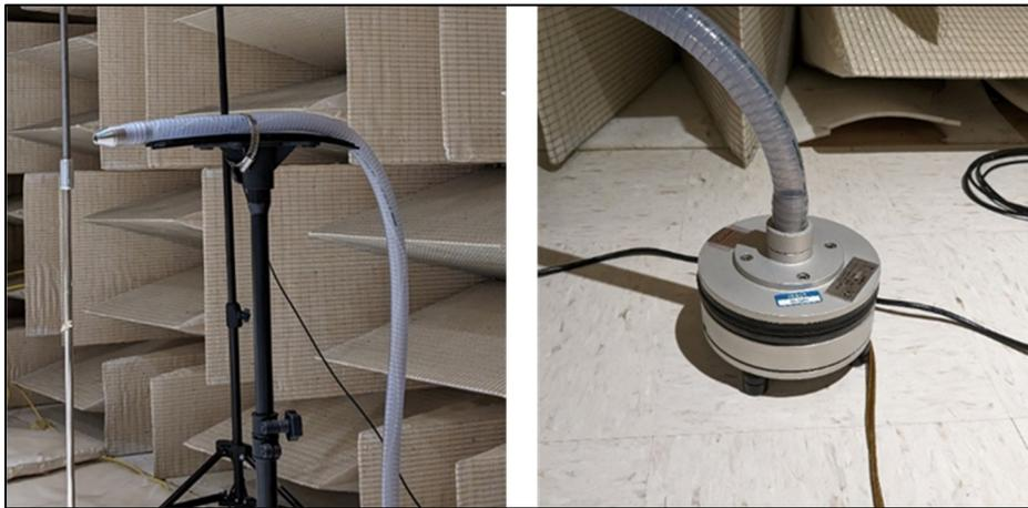
Figure-A II-1 Source volumique moyennes hautes fréquences LMS Qsource (Q-MHF, Q-MHF-ICP)
