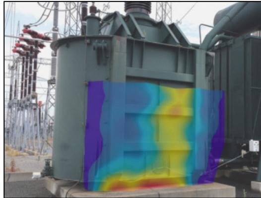
Figure 0.6 Image acoustique d'une machine obtenue par balayage avec une sonde intensimétrique
