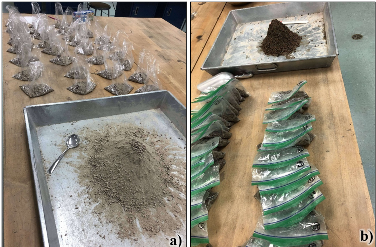
Figure 2.8 Pelletage fractionné sur des lots a) sec et b) humide
