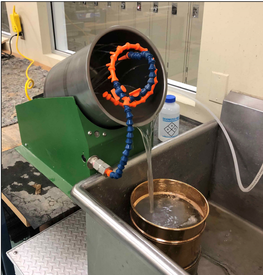
Figure 2.3 Dispositif de lavage d'importantes quantités de sol
