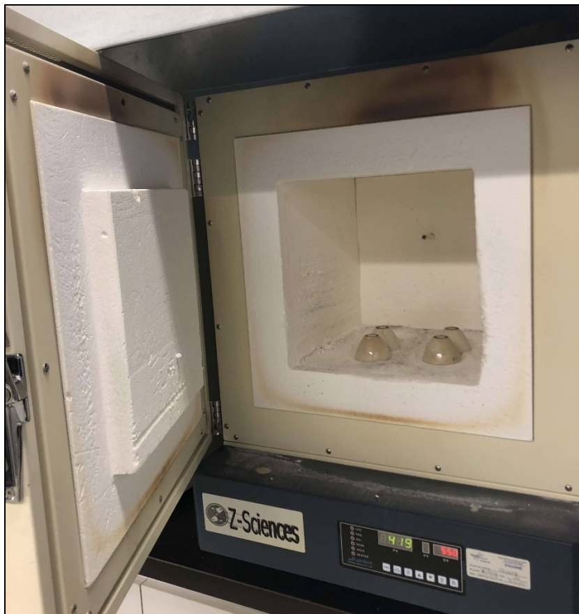
Figure 2.11 Photographie du four à moufle
