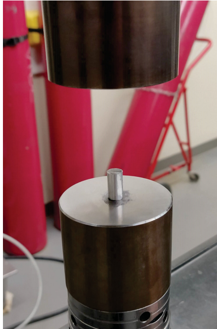
FIGURE 2.9 – Montage expérimental pour la réalisation des essais de compression sur des éprouvettes cylindriques de 20 mm de hauteur et 10 mm de diamètre.
