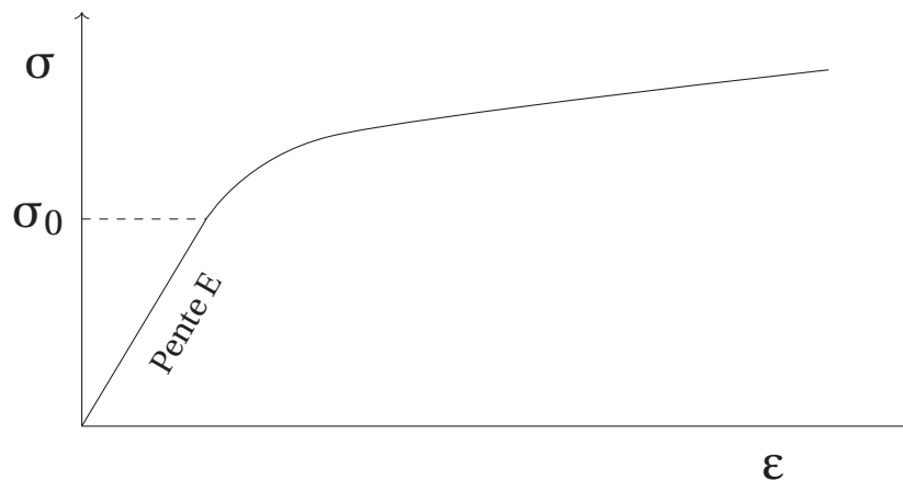
FIGURE 1.4 – Courbe contrainte - déformation d'un modèle d'élasto-plasticité avec écrouissage isotrope
