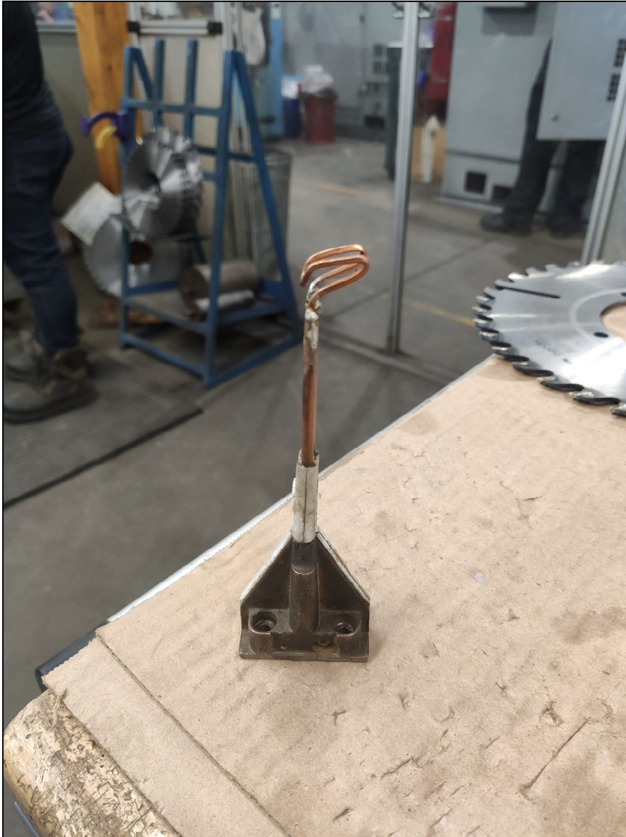
Figure 3.2 Anneau utilisé sur la machine de brasage Gerling Automation GLL à DK-Spec
