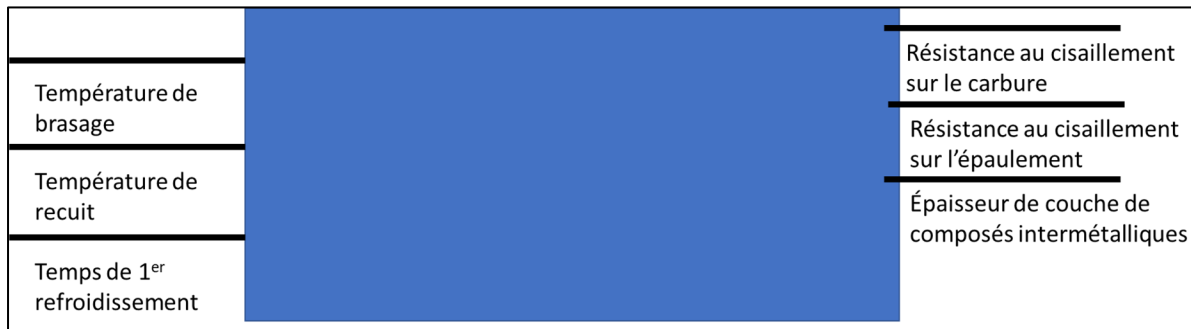
Figure 4.1 Plan d'expérience du cycle thermique avec recuit
