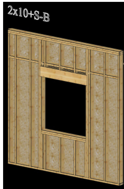
Figure 3.18 Exemple d'ouverture avec 3 linteaux
