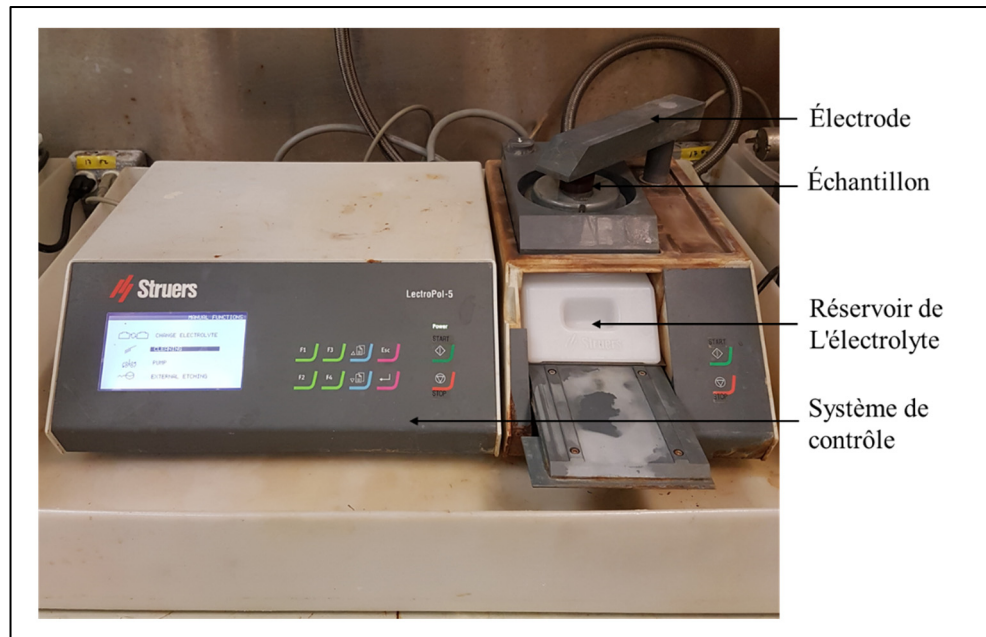
Figure 2.2 Machine d'électro-polissage utilisée dans cette étude pour préparer les échantillons de MEB
