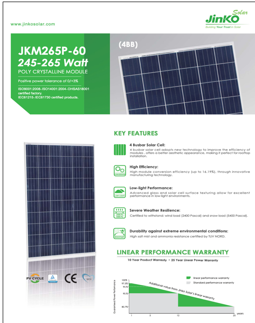
Figure-A I-1 Spécificités techniques des Panneaux solaires photovoltaïques Tirée de EN-JKM265P-60 (2023, p. 1)
