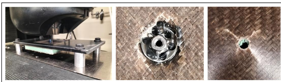
Figure 3.13 A gauche : Montage avant mise en traction, au milieu et à droite : allure de l'éprouvette recto-verso après rupture pour un insert Rotaloc ø23mm
