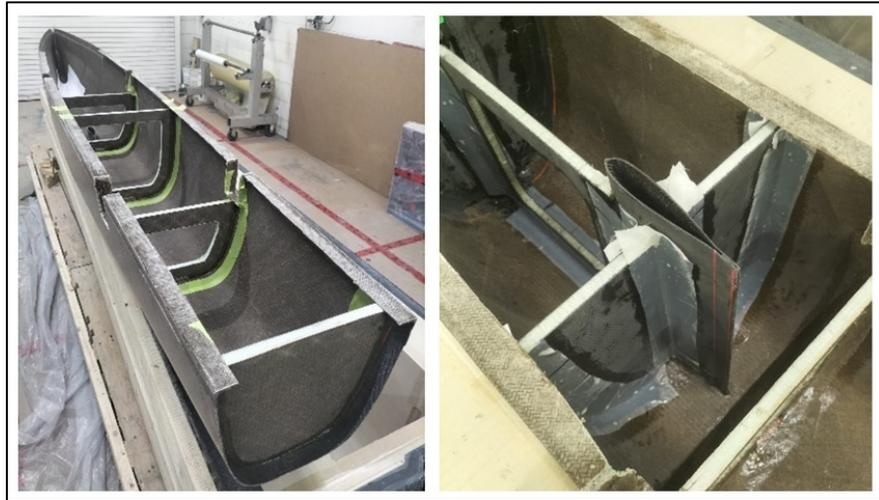
Figure 6.22 Collage des cloisons en lin (à gauche) et renforcement des joints par stratification contact (à droite)
