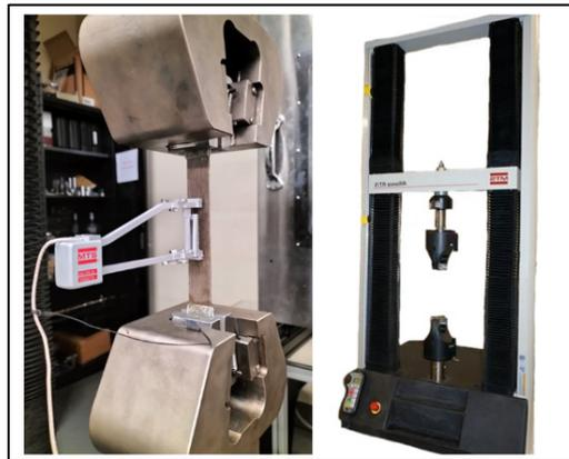
Figure 3.8 Éprouvette et extensomètre
