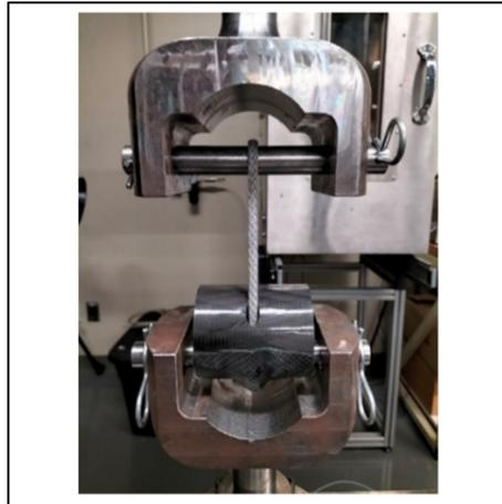
Figure 3.17 Éprouvette de test n°2 dans le montage de traction
