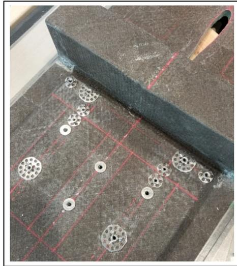
Figure 6.23 Placement des inserts dans le pont
