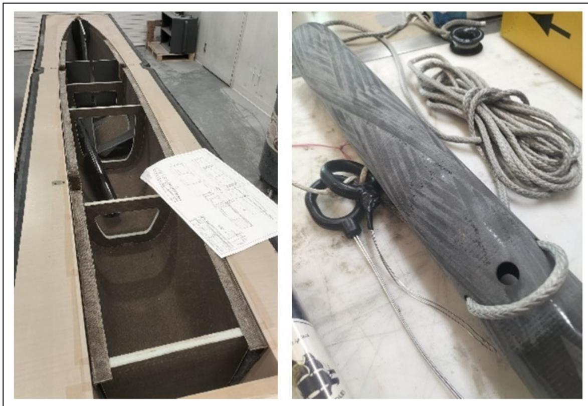
Figure 6.21 Ajustement des cloisons (à gauche) et ajout du point d'attache sur le pied de mât (à droite)
