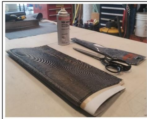
Figure 6.19 Placement des plis de carbone pour le puits de dérive
