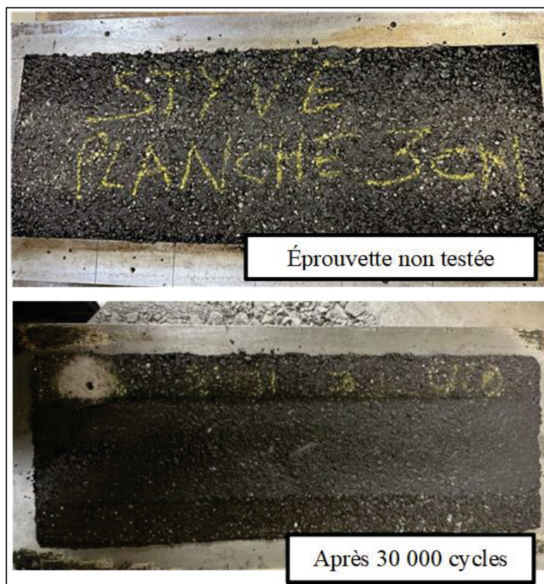
Figure 4.10 Présentation de l'éprouvette B4.0S25G avant et après le test d'orniérage modifié
