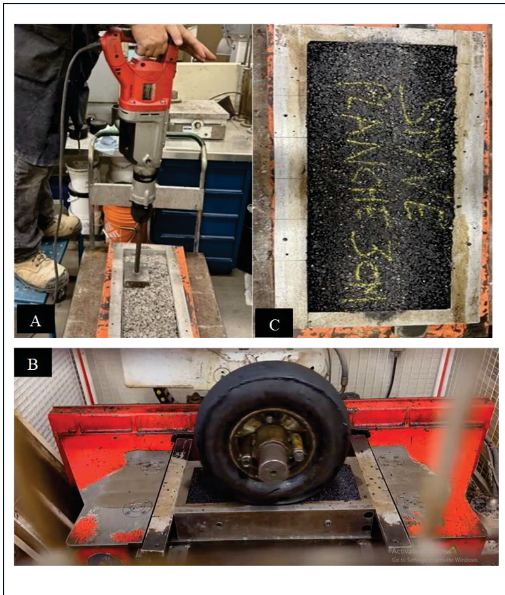
Figure 3.6 a. Compactage de la pierre concassée b. Compactage de l'enrobé sur la base granulaire c. plaque d'orniérage modifié
