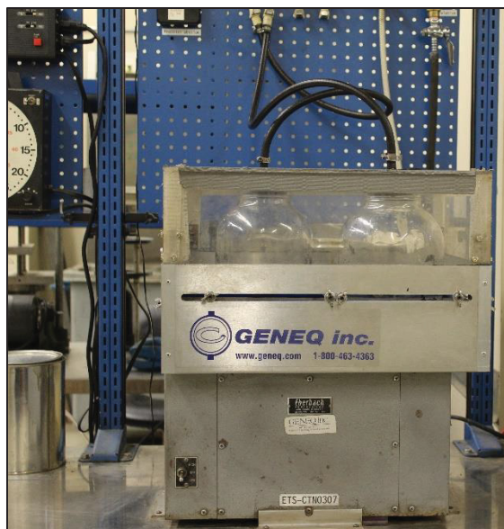
Figure 2.2 Essais de densité maximale
