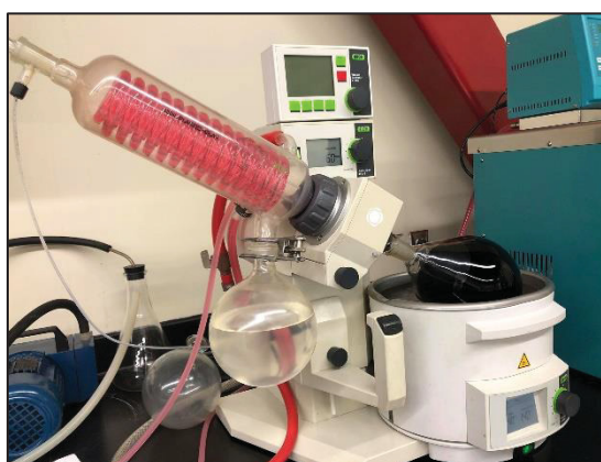
Figure 2.5 Distillation du trichloréthylène (TCE) au ROTOVAP
