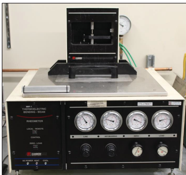
Figure 2.9 Rhéomètre à flexion de poutre (BBR)
