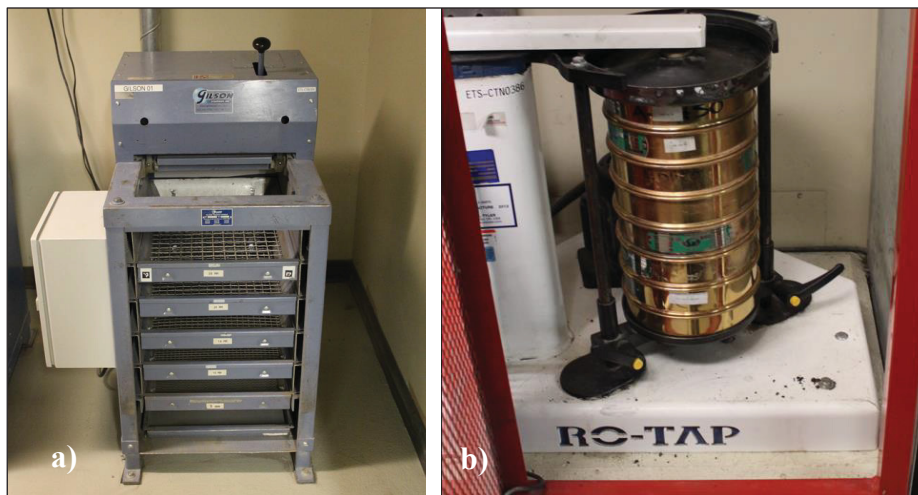
Figure 2.3 Appareils de tamisage : a) Tamisage des gros granulats (Gilson); et b) Tamisage granulats fins (Ro-Tap)
