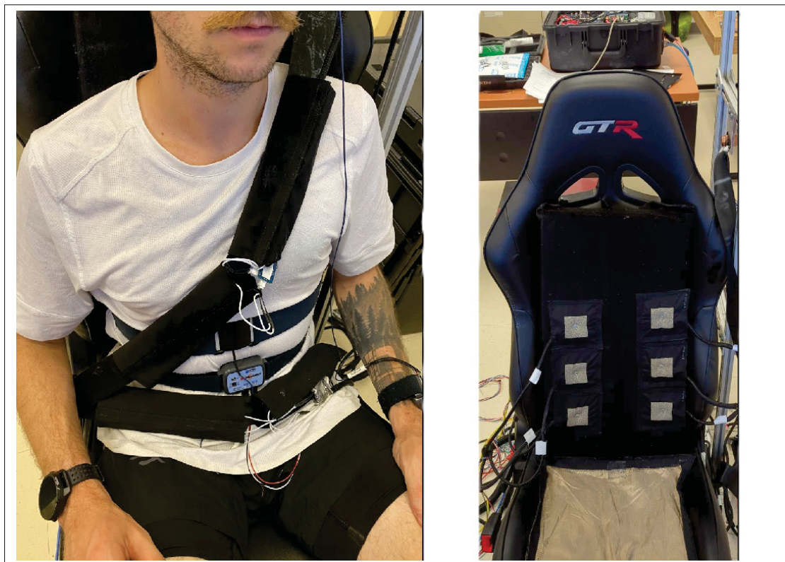
FIGURE 2.2 Système d'acquisition cardio-respiratoire et capteurs de références
