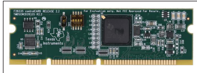
Figure 4.4 Carte de contrôle TMS320F28335
