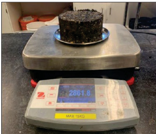
Figure 1.11 Mesure de la masse de l'éprouvette sur une balance numérique Tirée de Ogbo (2022)
