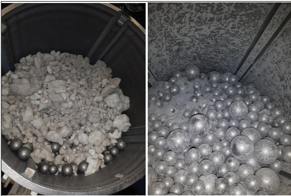
Figure 3.10 : Chambre du broyeur avant (gauche) et après (droite) le broyage
