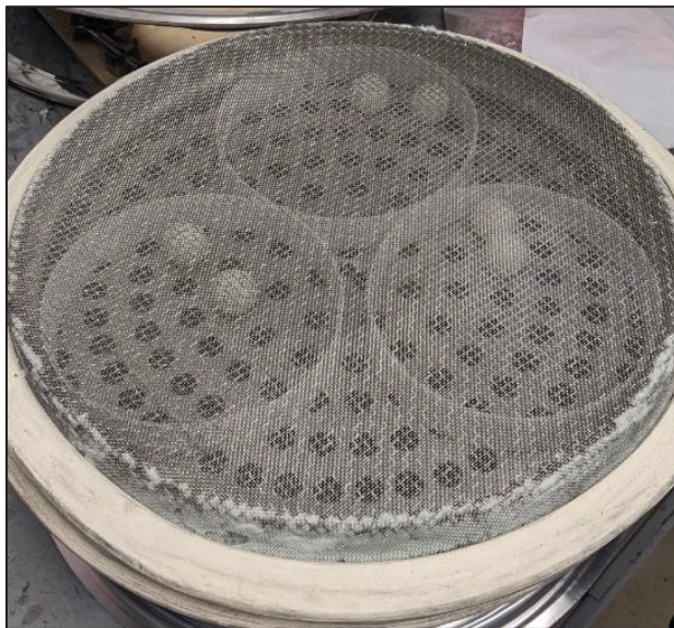
Figure 3.8 : Accumulation de fibres courtes sur le tamis inférieur de la tamiseuse
