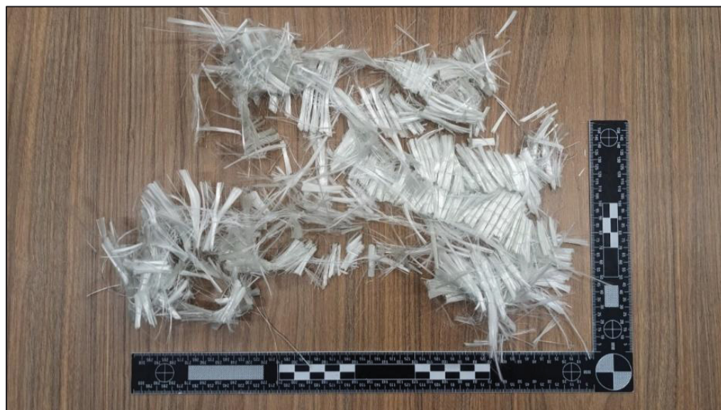
Figure 3.6 : Résultat du déchiquetage des textiles de verre sans tamis
