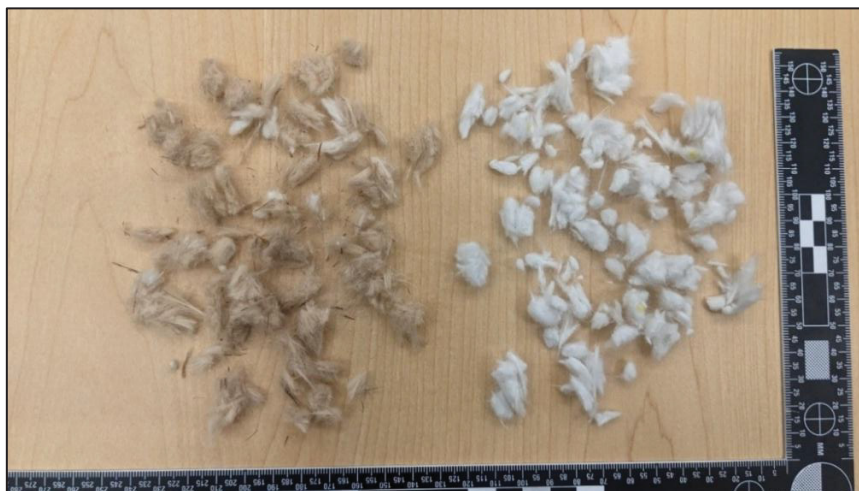
Figure 3.5 : Comparaison des agglomérats de fibres pyrolysés (gauche) et non pyrolysés (droite)
