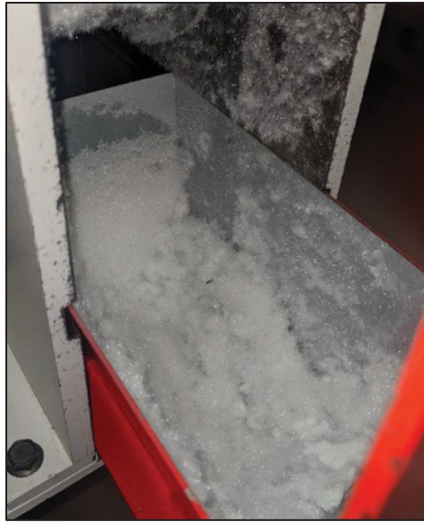
Figure 3.12 : Résultat du déchiquetage secondaire des agglomérats de fibres de verre
