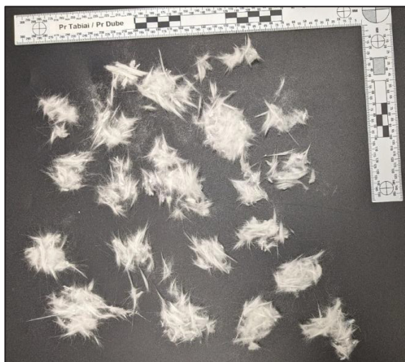
Figure 3.9 : Aplatissement des agglomérats de fibres de verre
