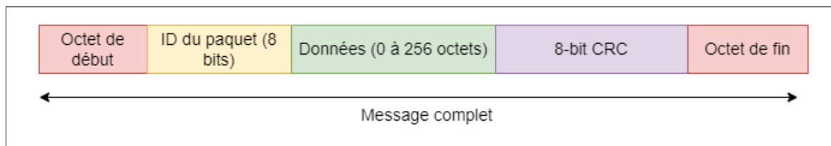
FIGURE 2.15 Structure d'un message sérialisé STM32-PC
