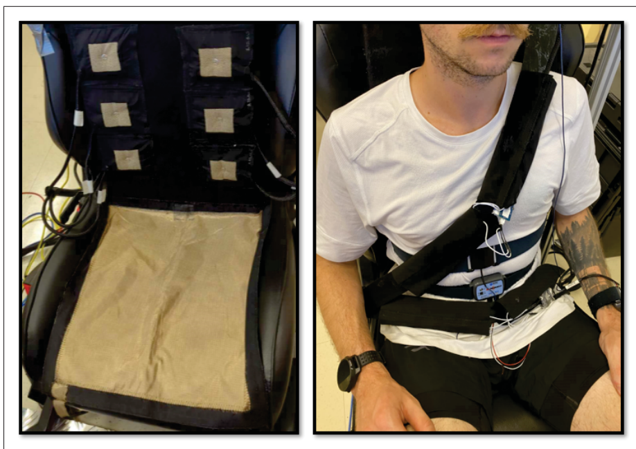
FIGURE 2.2 Système d'acquisition cardio-respiratoire et capteurs de références
