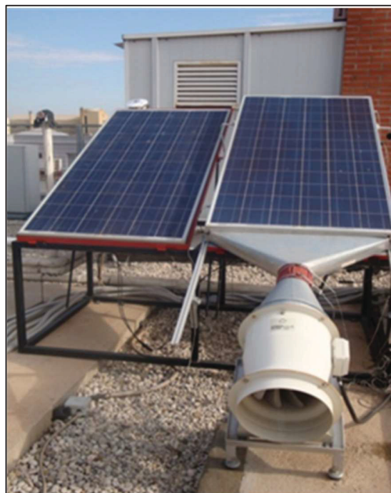
Figure 1.9 Installation expérimentale d'un système du refroidissement par ventilation artificielle
