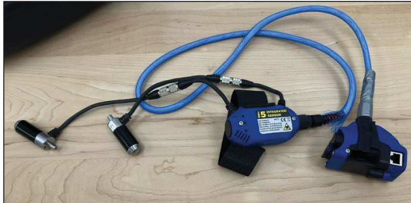
Figure 3.9 : Capteur i5 utilisé sur le MS HoloLens 2
