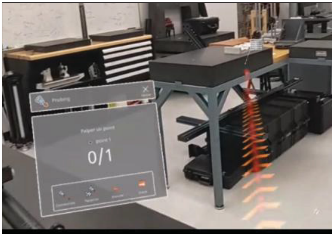
Figure 4.5: Validation de l'intégration : concordance des coordonnées entre Surveyor® et PolyWorks™ AR
