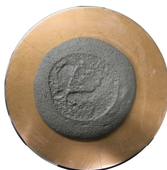
Figure 4.3| Illustration d'un étalement de 60% après 25 chocs de la table à percussions (norme ASTM C1437 [21])
