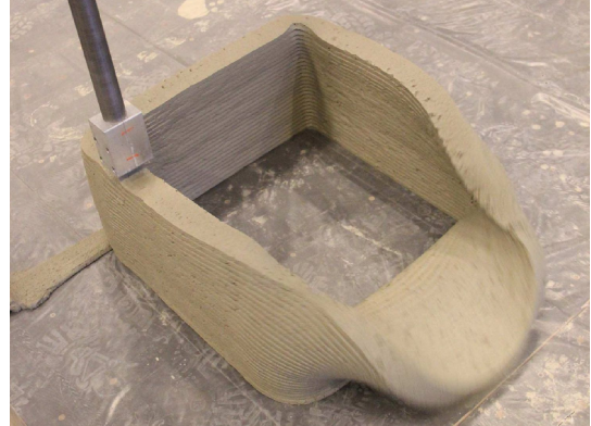
b. Flambement élastique d'un mur de 500 mm de périmètre
