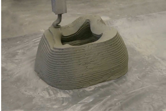
a. Effondrement plastique d'un mur de 250 mm de périmètre
