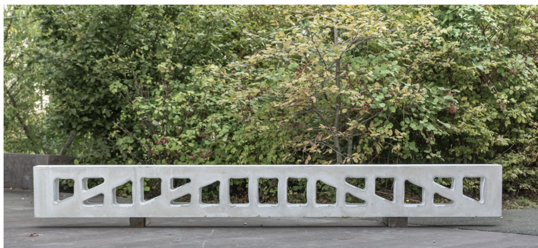
Figure 1.6 | Poutre renforcée optimisée topologiquement grâce à l'impression 3D d'argile présentant une réduction du poids estimée à 48% par rapport à une poutre classique [198]
