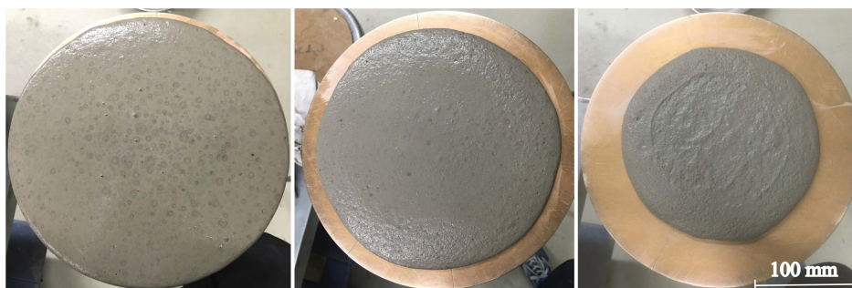
Figure 4.10 | Exemples de différentes valeurs d'étalement de gauche à droite : 150% - 120% - 82%
