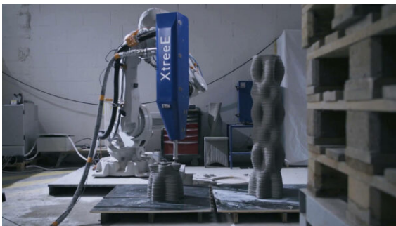
a. Cellule d'impression 3D usant d'un robot industriel 6 axes - https://xtreee.com/
