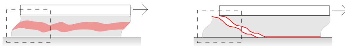
Figure 2.13 | Illustration des types de déformations pour un fluide à seuil plastique (gauche) et un solide fragile (droite) [83]
