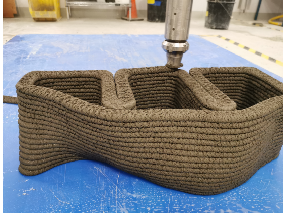
a. Exemple d'extrusion présentant un phénomène de déchirement du cordon - ÉTS
