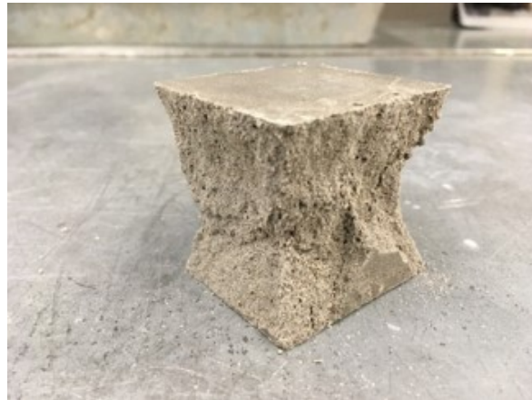
Figure 4.15 Exemple d'un cube de 50 mm après rupture lors d'un test de résistance à la compression
