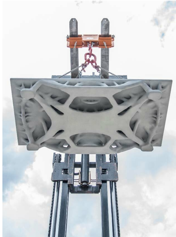
Figure 1.7 | Dalle optimisée topologiquement permettant une réduction du poids de la structure allant jusqu'à 70% [142]
