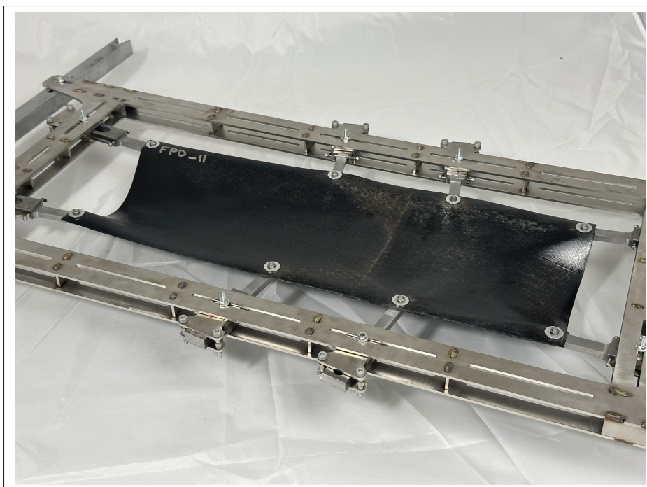
Figure 3.16 Déformation du flanc (section épaisse à gauche) lors de la chauffe dans le four infrarouge
