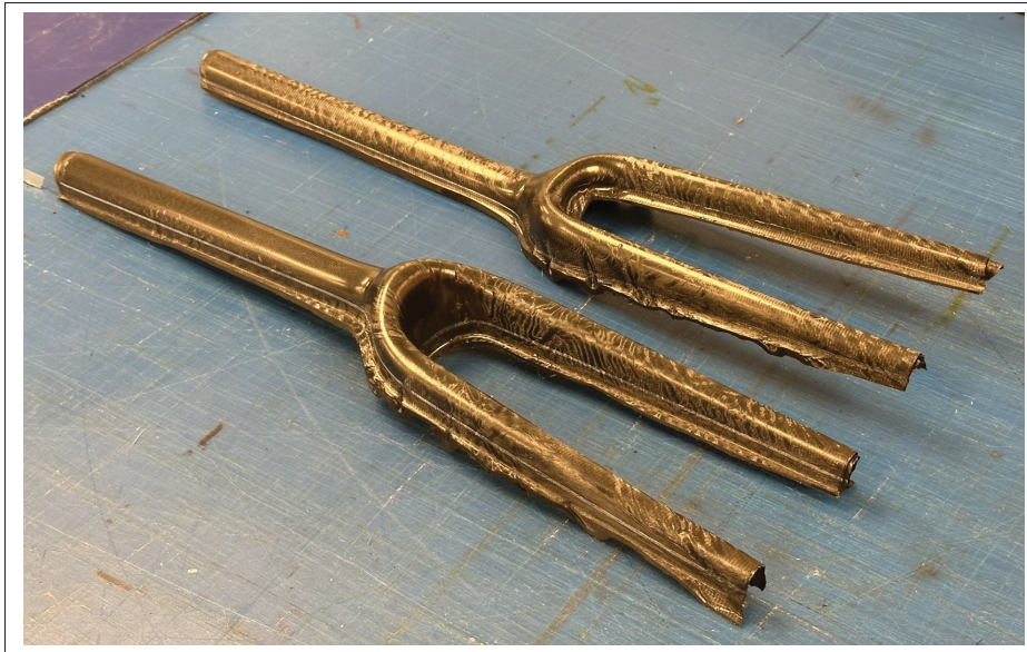
Figure 4.7 Découpe grossière des demi-coques avant et arrière avec une scie à ruban. Le contour à découper est tracé à l'aide du moule de consolidation
