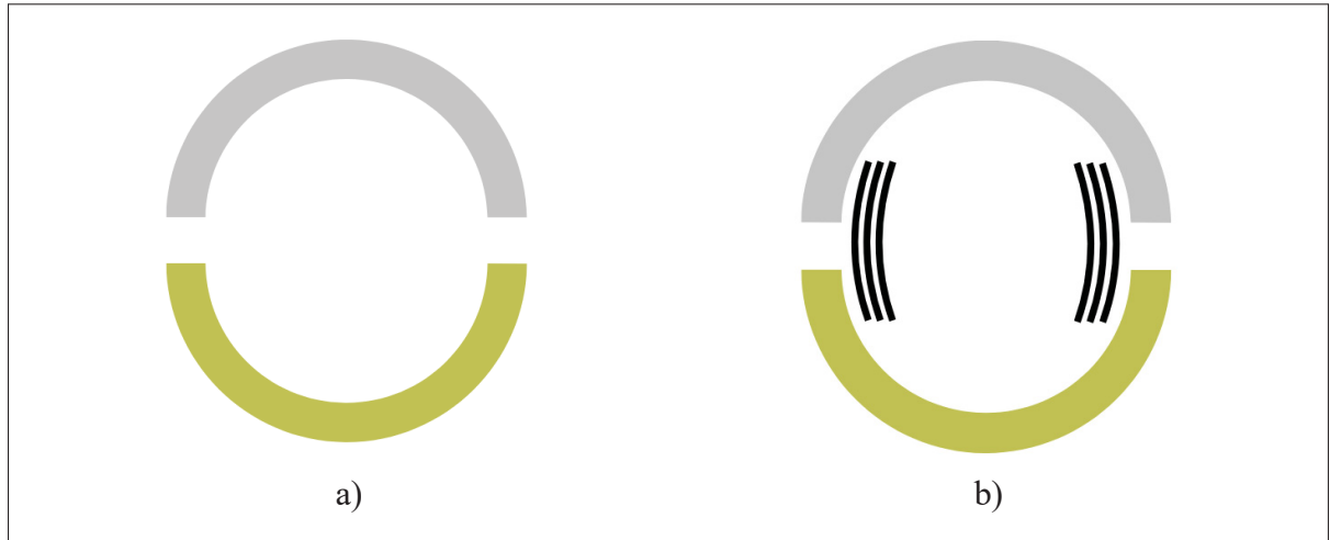
Figure 4.6 Schémas des deux configurations de joints pour la consolidation avec vessie. Un joint bout à bout (a) et un joint avec recouvrement (b) sont considérés
