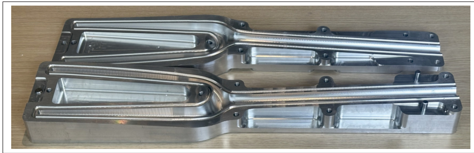
Figure 4.1 Photographie des deux cavités formant le moule de fabrication de la vessie avec le matériau Mosites #1453
