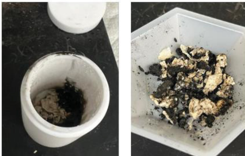
Figure 3.2 Résidu solide noir observé à la fin de la dégradation du PET en milieu basique par micro-ondes
