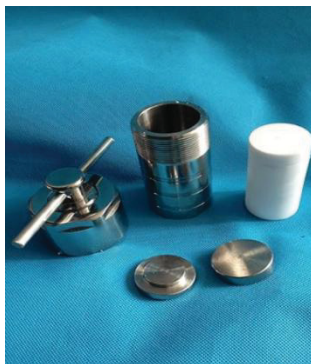
Figure 2.1 Réacteur autoclave de synthèse hydrothermique
