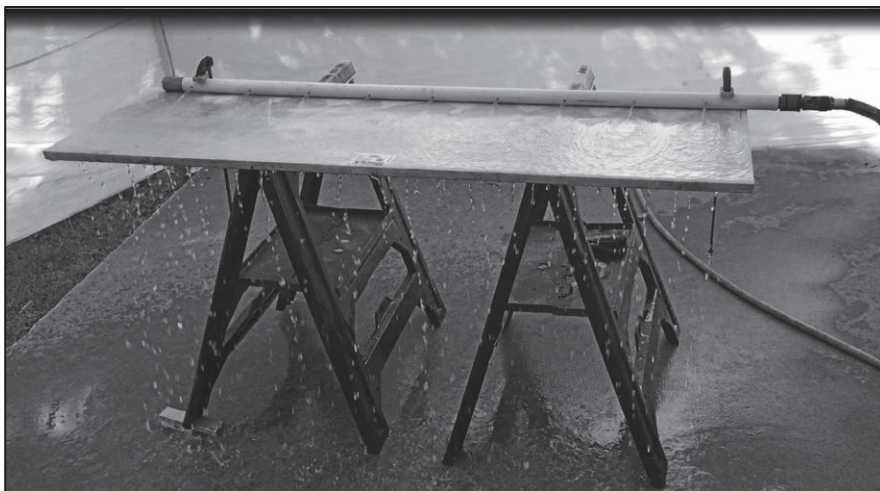
Figure 1.9 Système de mouillage à écoulement en nappe Tiré de Johnson et al. (2017)
