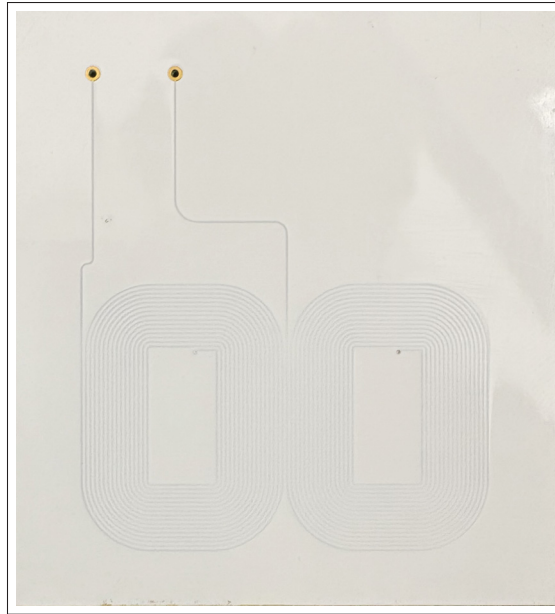
Figure 3.1 Photographie de la face inférieure de PCB en oxyde d'alumine ( \text{Al}_2\text{O}_3 )
