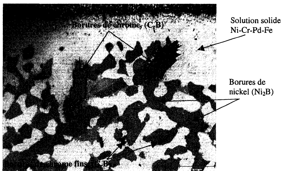
Figure 72 Micrographie identifiant les principales structures présentes dans la région eutectique d'un joint brasé avec l'alliage CPW 475 (grossissement initial 500 X)
