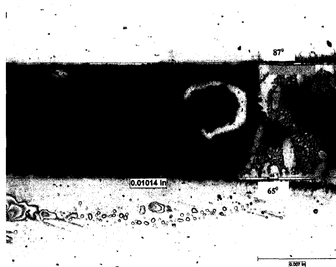
Figure 63 Micrographie illustrant l'écoulement du métal d'apport pour un joint brasé avec l'alliage BNi-2 sur une surface grenillée à l'oxyde d'aluminium
