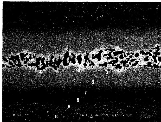
Figure 56 Microstructure MEB type montrant l'ensemble d'un joint brasé avec l'alliage CPW 475 suite à un brasage prolongé de 120 min.
