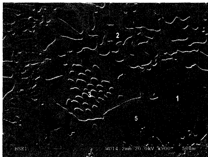
Figure 40 Microstructure MEB type montrant l'aspect général d'un joint brasé avec l'alliage BNi-2 après un traitement de diffusion de 240 min.
