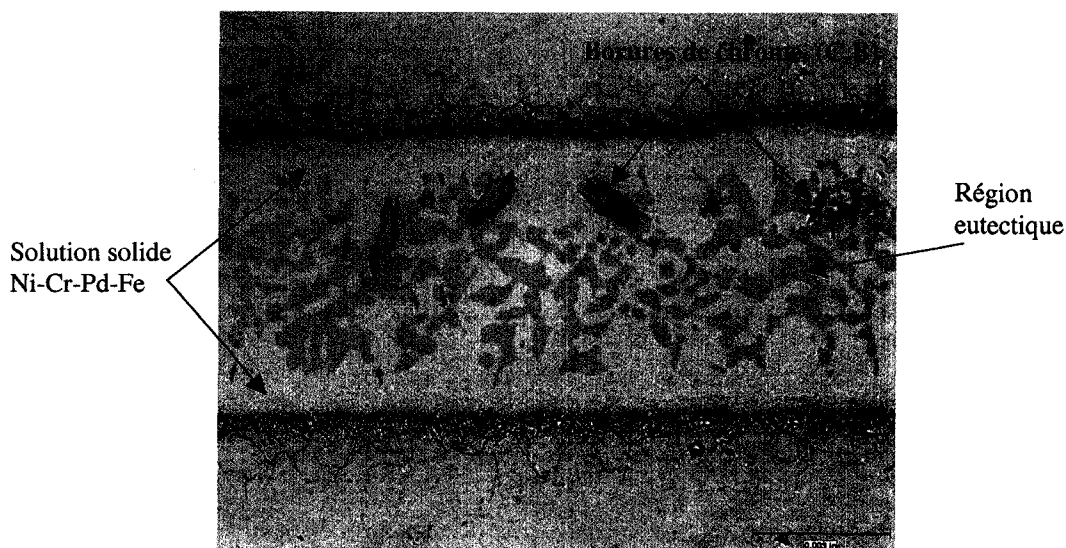
Figure 71 Micrographie identifiant les principales structures présentes dans un joint brasé avec l'alliage CPW 475 (grossissement initial 200 X)
