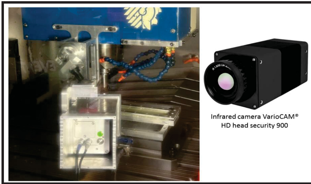
Figure 2.11 Caméra thermique dans son boîtier protecteur en aluminium
