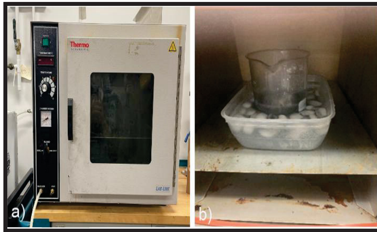
Figure 2.5 a) étuve b) mélange de cire, graphène ajoutée à la résine
