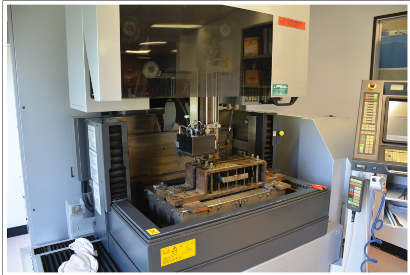
Figure 4.14 Préparation à la coupe par EDM
