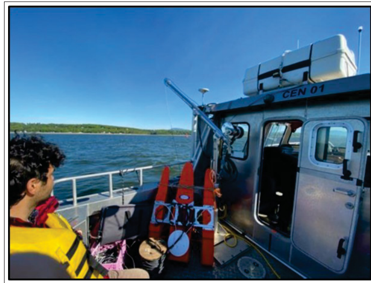
FIGURE 2.2 Dispositif d'acquisition bathymétrique avec le sonar multifaisceaux
