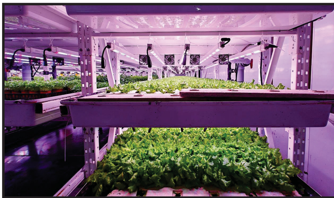
Figure 4.8 Bassins modulaires automatisés, capteurs de contrôles pour l'éclairage et irrigation
