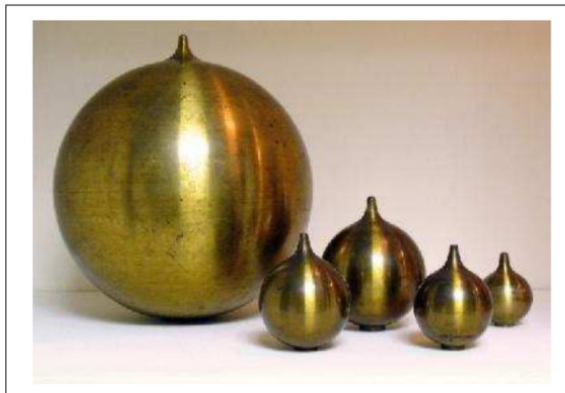
Figure 1.2 Résonateurs de Helmholtz Tiré de Roche et al. (Roche, 2011)
