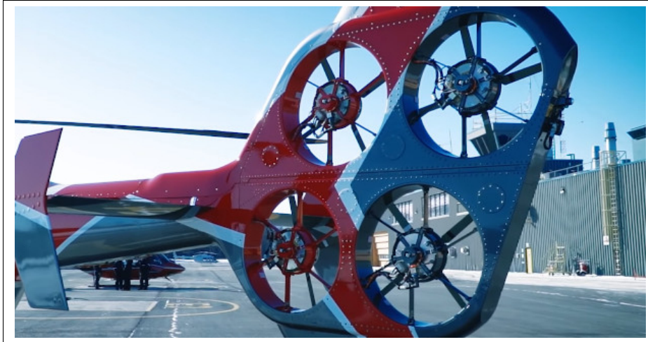
Figure 0.2 Le démonstrateur EDAT et ses quatre rotors de queue carénés
