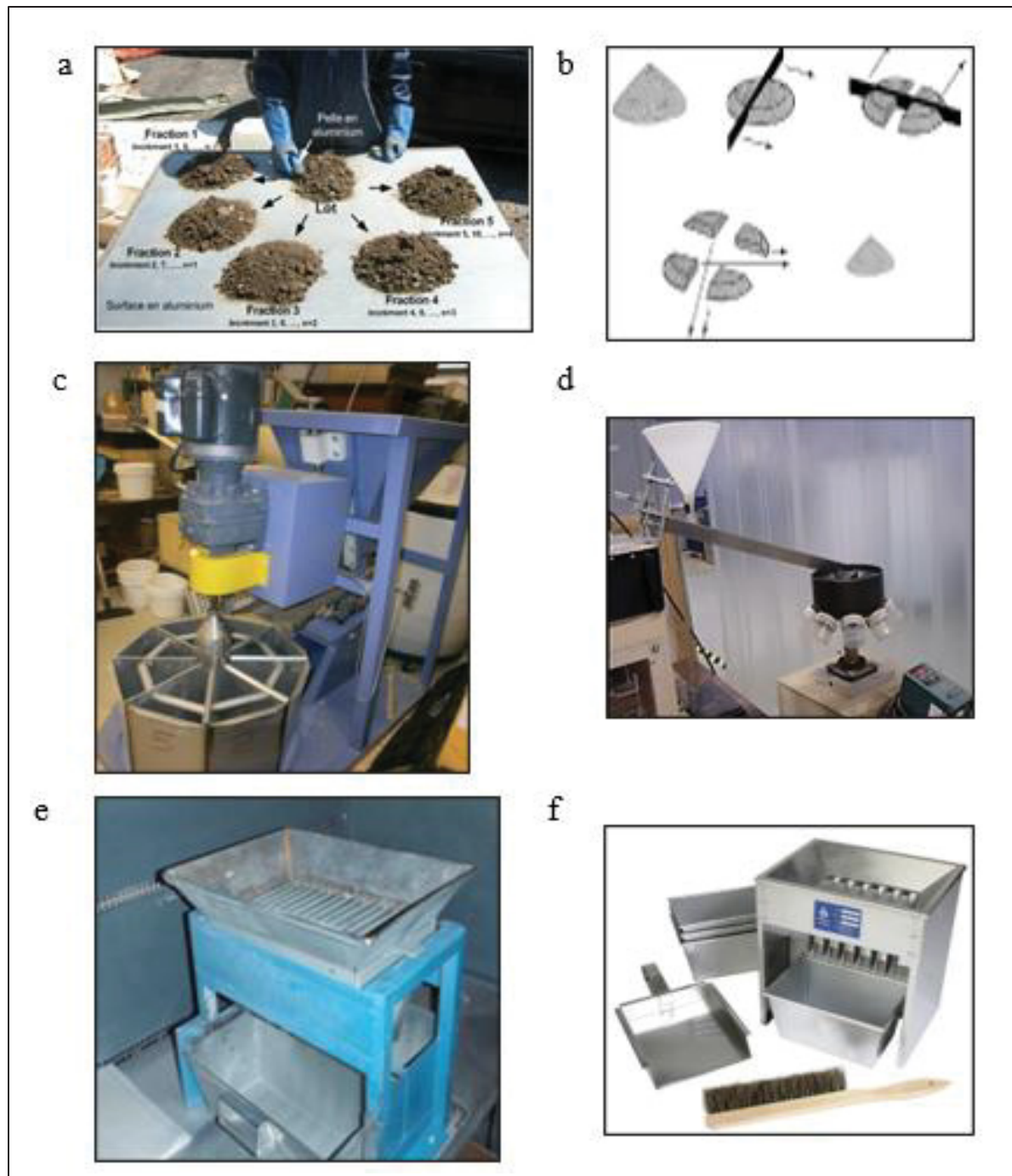
Figure 1.10 Réduction de masse par fractionnement : (a) pelleting fractionné, (b) quartage, (c - d) séparation sectorielle rotative pour les gros et les petits tailles des particules , (e-f) séparateur à chutes pour les gros et les petits tailles des particules Tiré de Gerlach et Nocerino (2003); GENEQ (1972)
