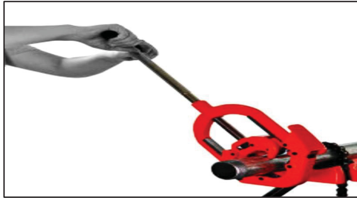
Figure 5-3 Coupe-tube manuel monté sur étau pour découpe de tubes métalliques, pouvant permettre de limiter les vibrations transmises au substrat lors du désassemblage des convertisseurs catalytiques
