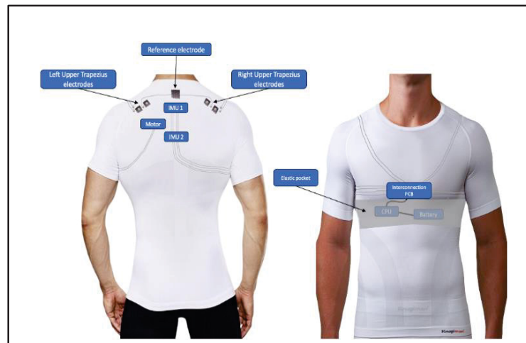
Figure-A X-2 Vêtement intelligent intégrant des capteurs IMU et des électrodes sEMG pour le suivi postural
