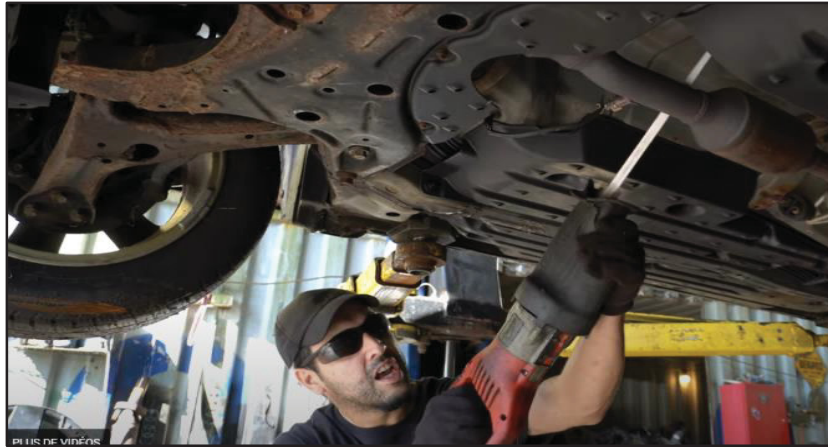
Figure 3-5 Découpe d'un convertisseur catalytique à la scie alternative Tiré de iScrap App (2024), "[Part 3] Cutting Catalytic Converters the Right Way: " (YouTube)
