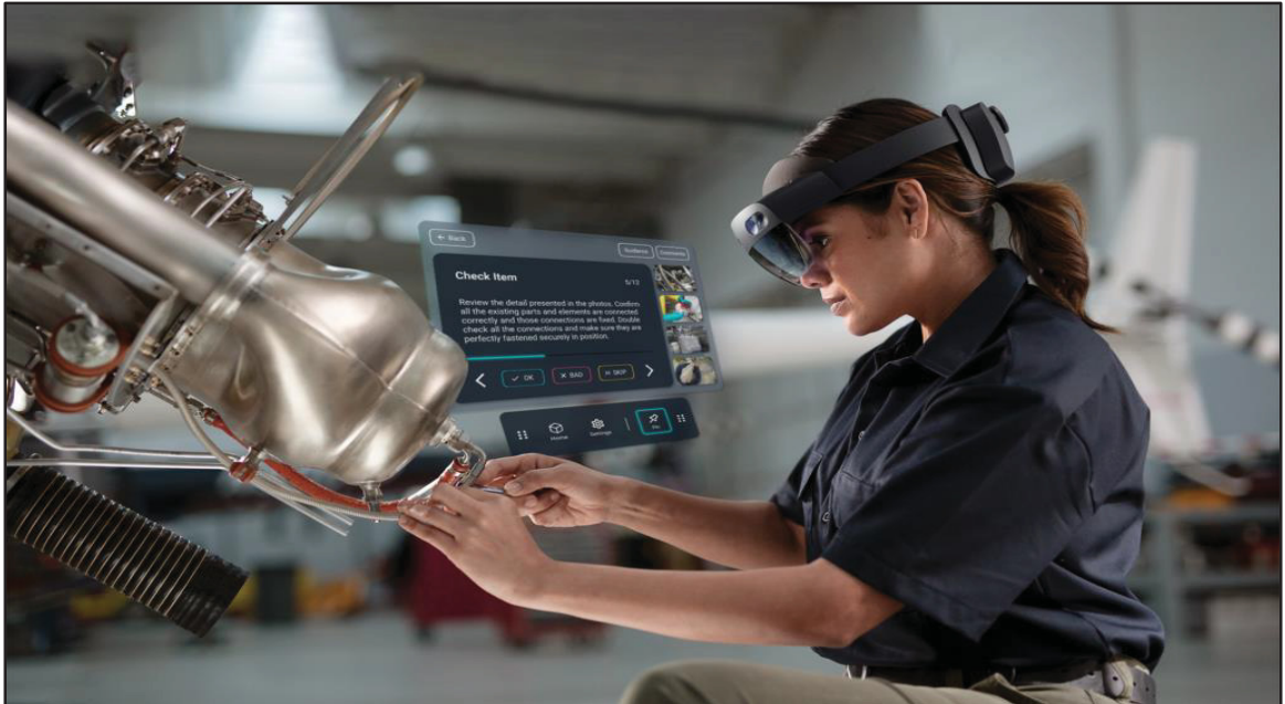
Figure-A X-4 Illustration d'un affichage pas-à-pas en réalité augmentée avec le HoloLens 2, pour guider l'opérateur lors d'opérations techniques Tirée de Augment IT ( https://augment-it.com )
