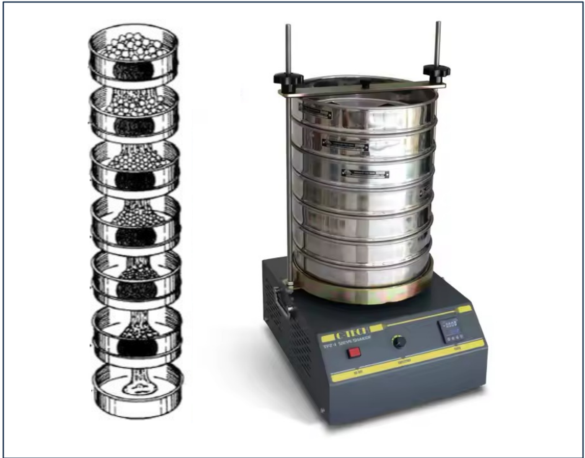
Figure 1.2 Dispositif expérimental du tamisage pour l'analyse granulométrique Tiré de Tian (2024)
