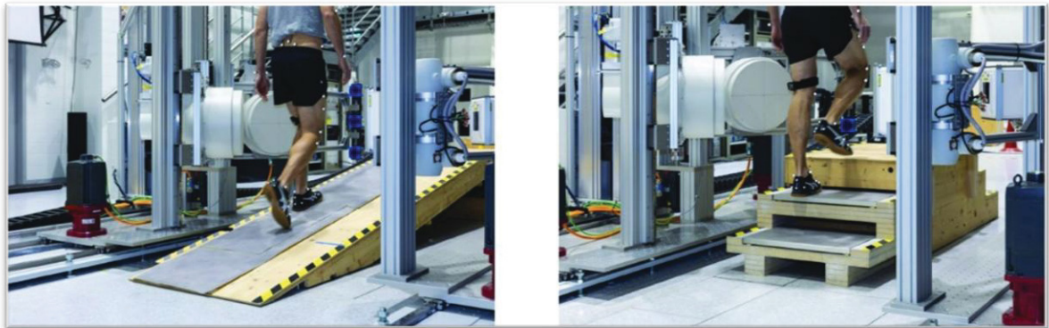
Figure 1.12 : Marche inclinée et montée d'escaliers mesurés par fluoroscopie biplanare Tiré avec autorisation de Planta et al. (2025), Creative Commons Attribution License
