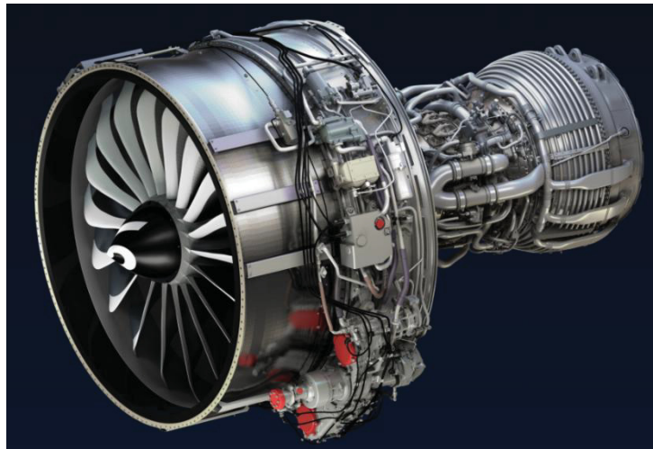
Figure 1-2 Moteur LEAP-1A par CFM International Adapté de Safran Aircraft Engines
